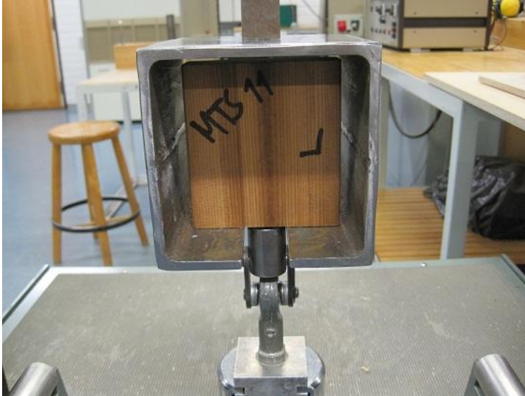
Kuva 4 Mekaanisen kiinnikkeen tartuntalujuuden vetotesti pituuden suunnassa
