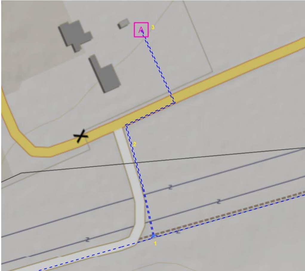
Kuva 4. Esimerkki asiakkaan laitteiston dokumentoinnista. Tässä tapauksessa kyseessä on muuntamo. Järjestelmään on dokumentoitu keskijännitekaapeleiden jatkokset (1), keskijännitekaapelit (2) sekä muuntamo (3).
