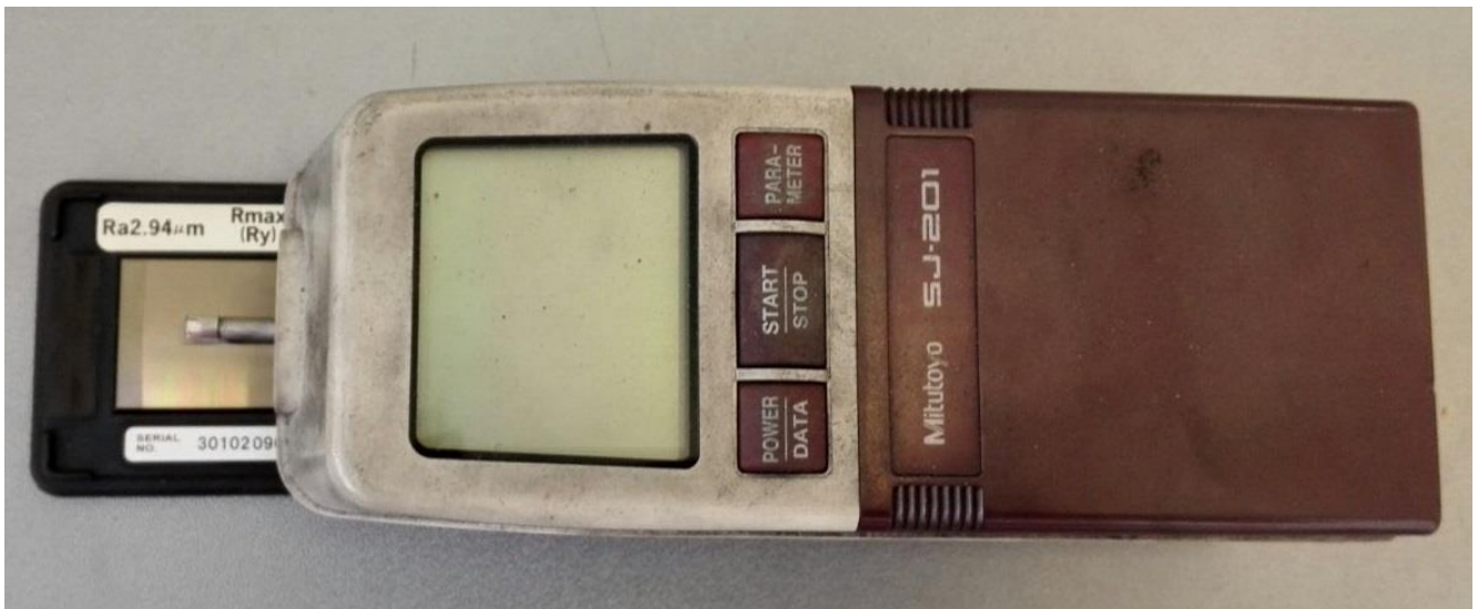
KUVA 1. Mitutoyo SJ-201 -digitaalinen pinnankarheusmittari ja kalibrintipala (Wintech Oy 2016)
