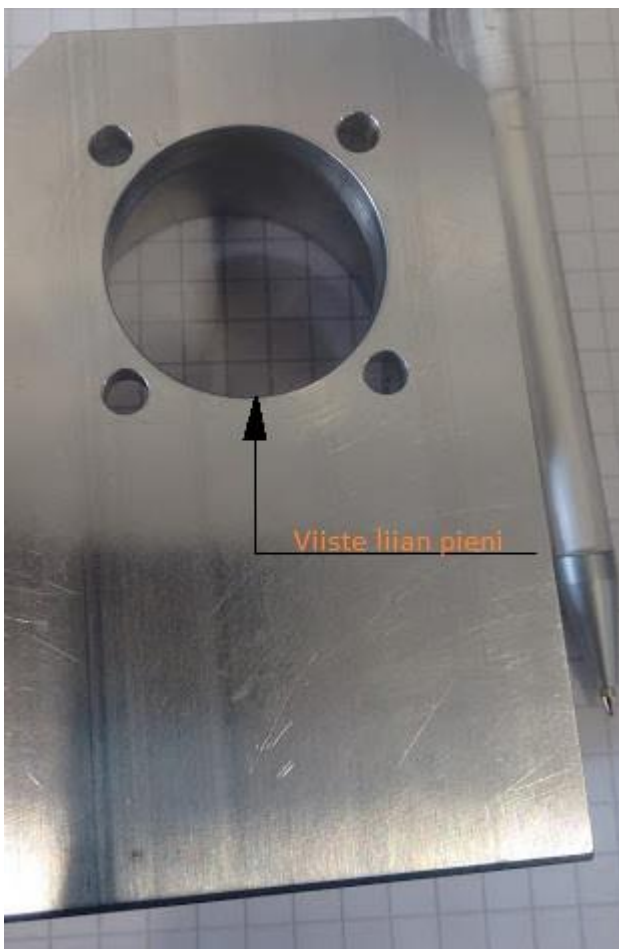
KUVA 5. Osan viiste havaittiin kokoonpanovaiheessa liian pieneksi (Wintech Oy 2016)
