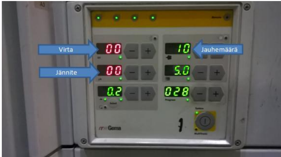
KUVIO 25. Ohjausyksikkö. Virta (kV) ja jännite ( \mu\text{A} ) nolla arvo
