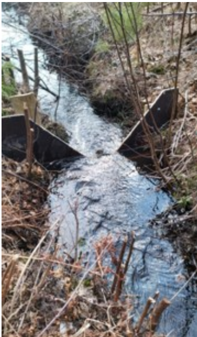
Kuva 2: V-mittapato purkuojassa (Oma valokuva)
