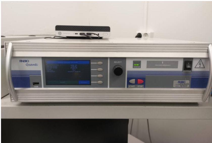
KUVA 13. Fineron Quanti I – eristysvastusmittari
