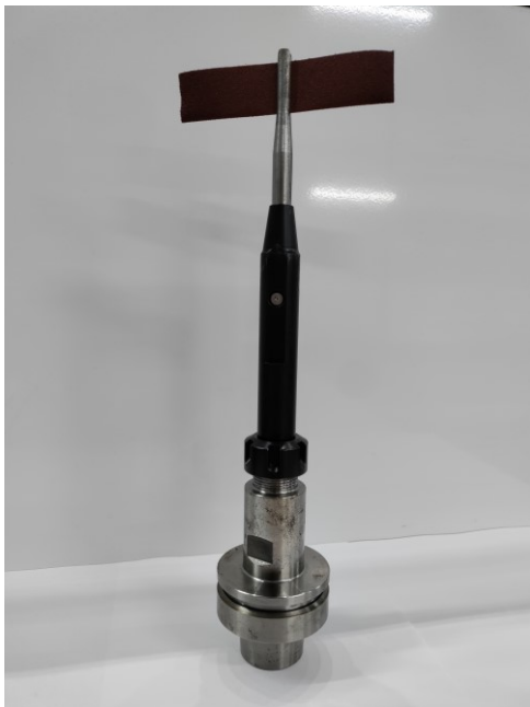
Kuva 17. Hiekkapaperinpidin eli lärppä.
