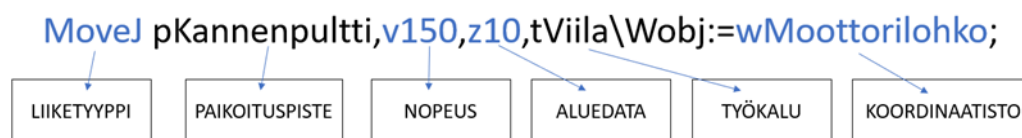
Kuva 5. ABB -robotin nivelliike käskyexample.
