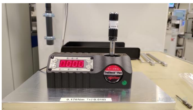
Kuva 29. Momenttiavain pystyasennossa kalibraattorilla
