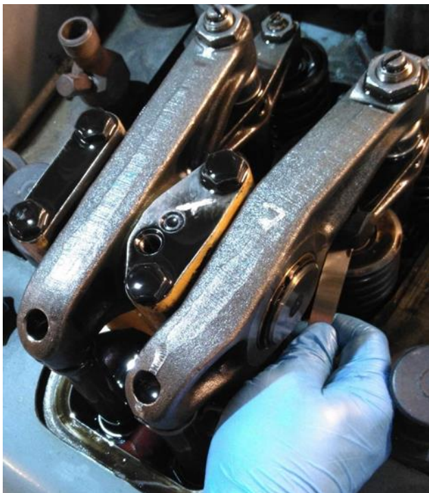
Kuva 10. Keinuvivut ja välyksen mittaus (Akseli Rantanen)
