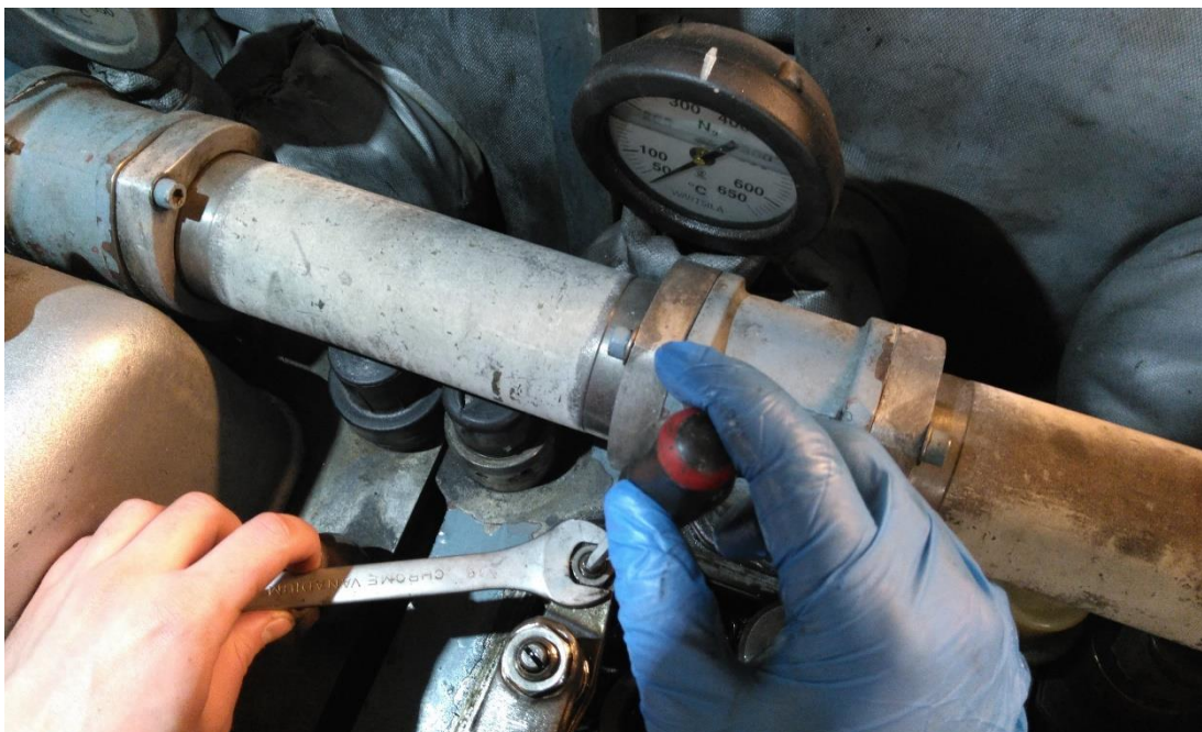
Kuva 11. Venttiilivälkyksen säätöä älylasien avulla (Akseli Rantanen)
