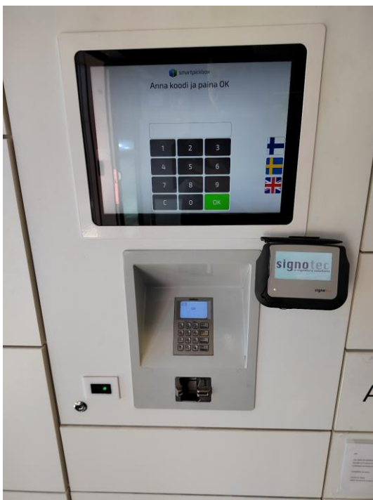
Kuva 3. Smartbox-palveluautomaatin näyttö, maksupäätte ja sähköinen allekirjoitin.
