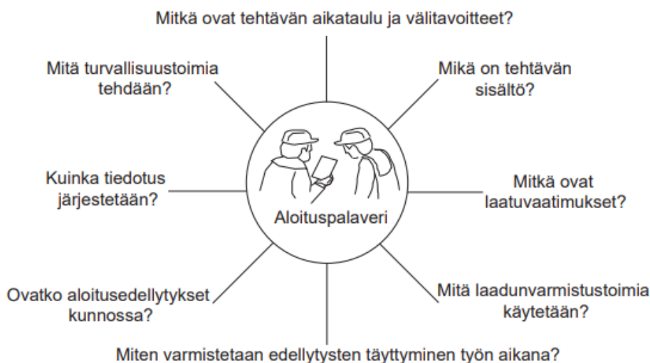
KUVA 2. Aloituspalaverissa varmistutaan, että tekijöillä on yhtenevä käsitys työnjohdon kanssa työn sisällöstä, vaatimuksista ja vastuista (Ratu S-1228)
