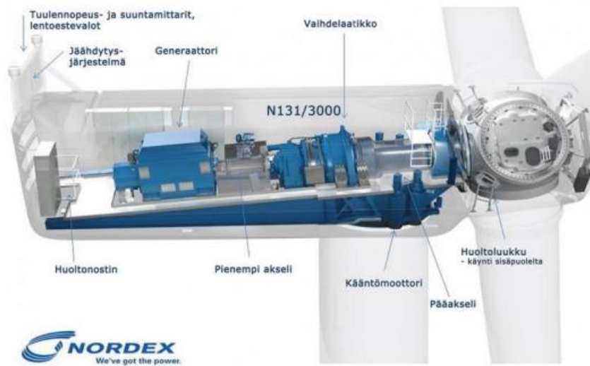
Kuva 10. Tuuligeneraattorin komponentit (Nordex N131/3000)
