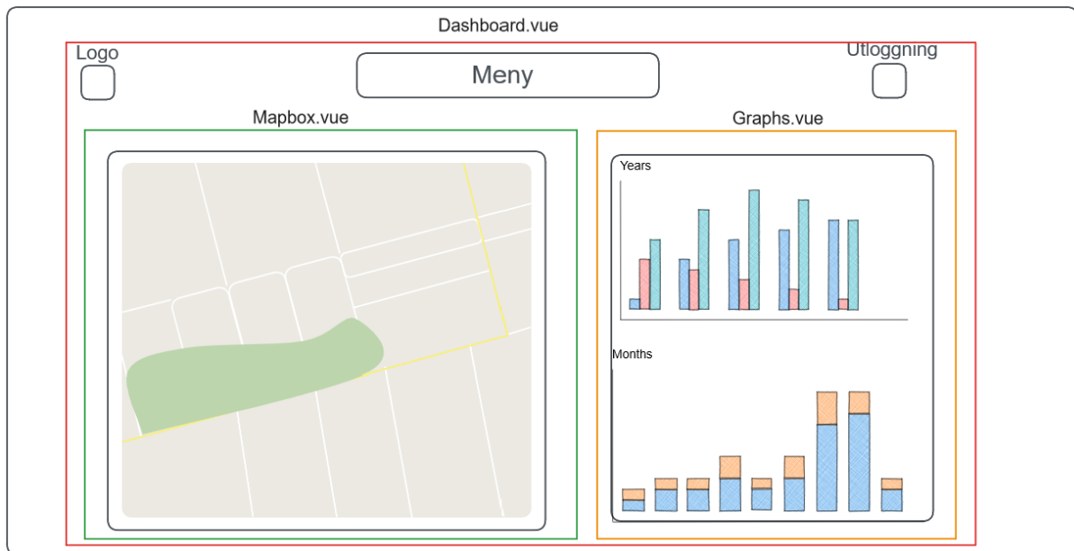
Figur 15. Tydligare figur på hur komponenterna är uppdelade i layouten
