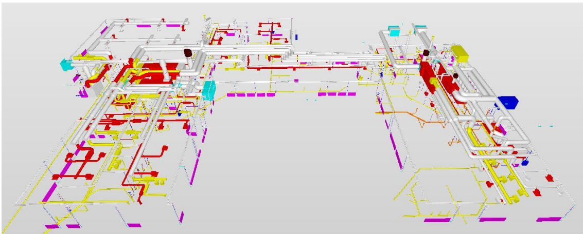
KUVA 1. IFC-malli rakennuksen LVI-järjestelmistä
