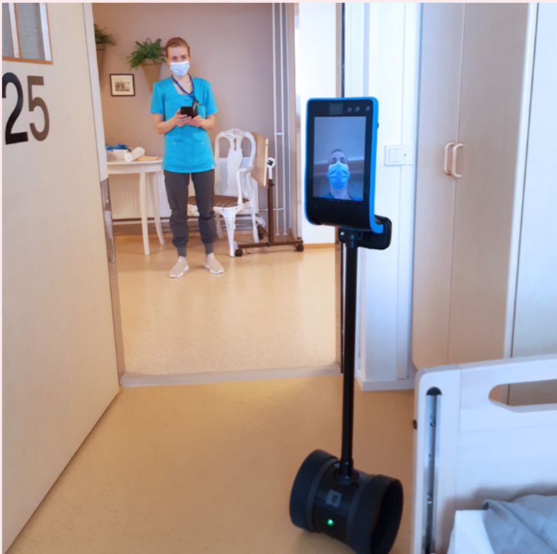
Hoitaja ohjaa puhelimellaan asukkaan huoneessa kiertävää Double 3 - etäläsnaolorobottia.
