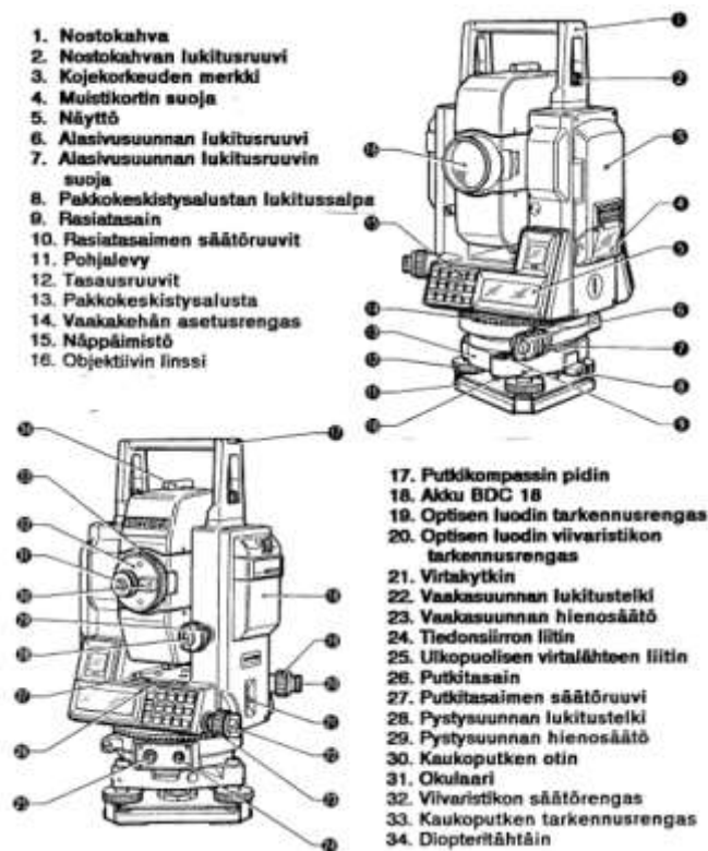
Kuvio 2. Sokkisha-merkkinen takymetri. (Kytölä 2008, 9)
