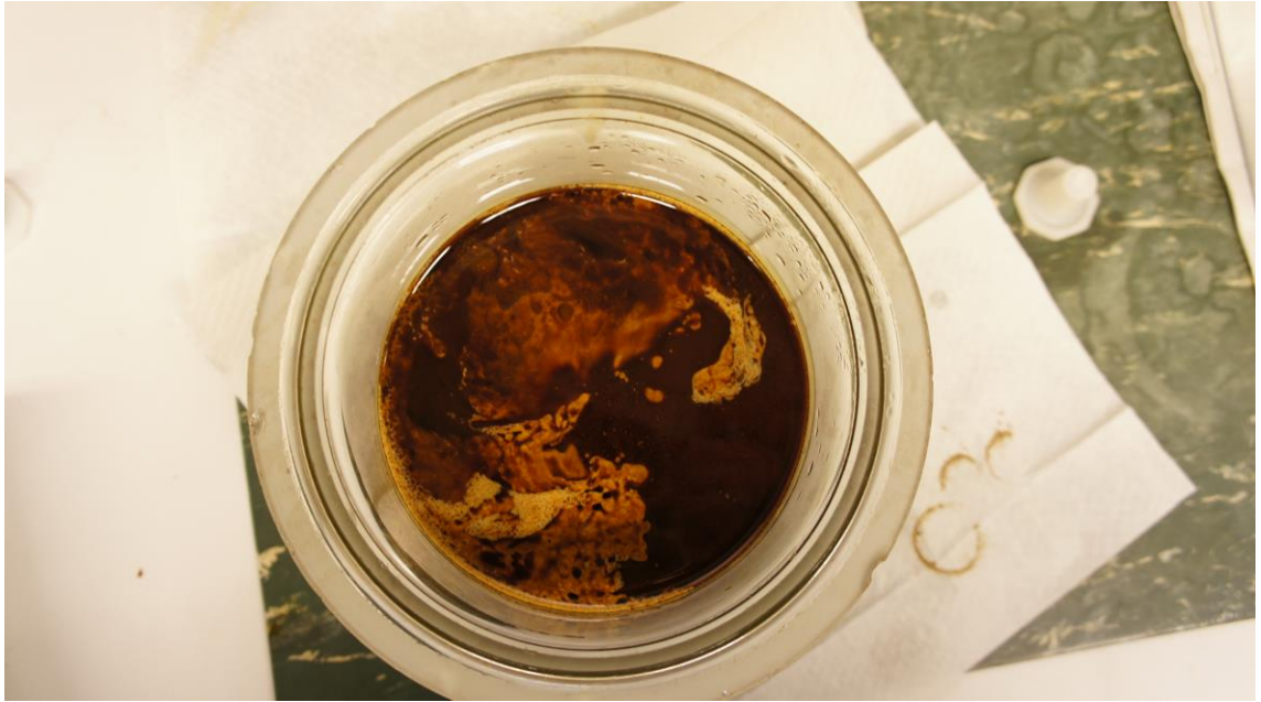
Kuva 10. Emulsiokoe mäntypikiöljyllä 3200 rpm
