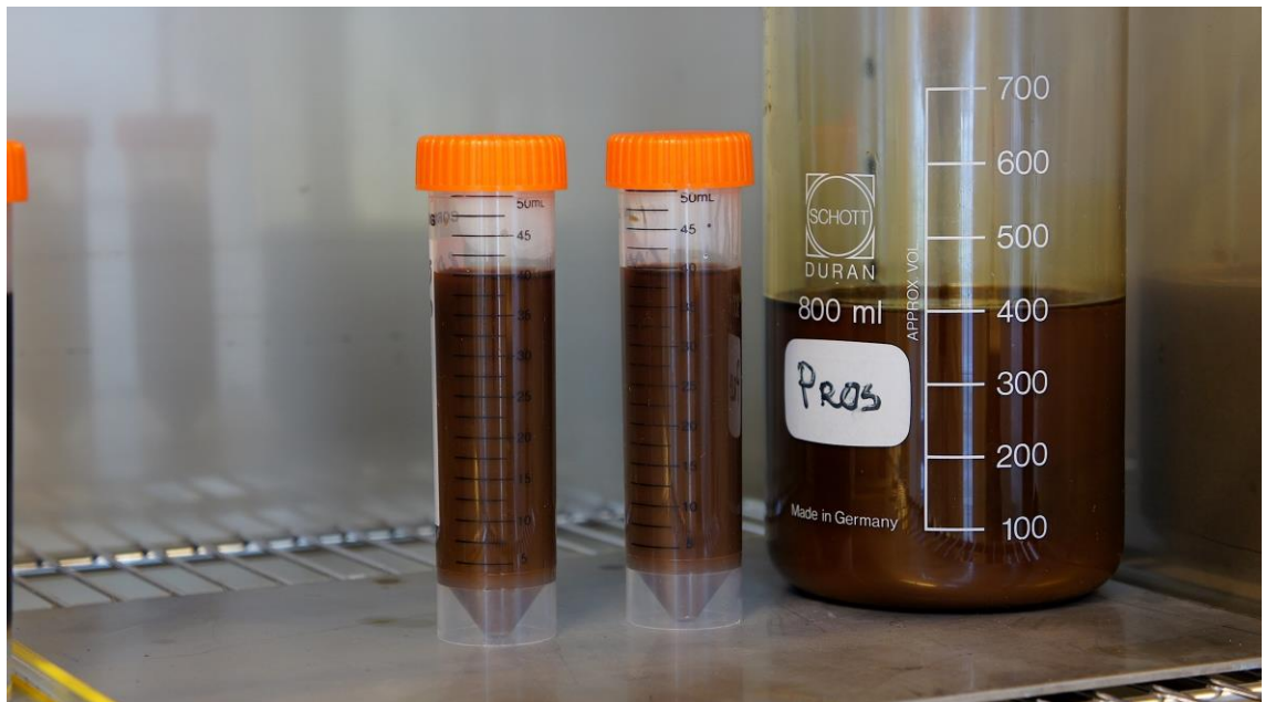
Kuva 11. Emulsiokoe mäntypikiöljyllä 6000 rpm.
