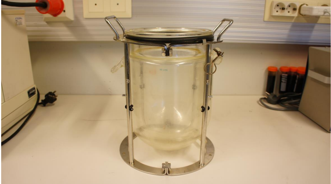
Kuva 2. 3,7 litran sekoitusastia jossa vaippa vesihauteelle.
