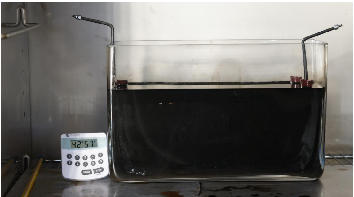
Kuva 20. Käytetty voiteluöljy + sitruunahappo. Ei juuri lainkaan vettä astian pohjalla.
