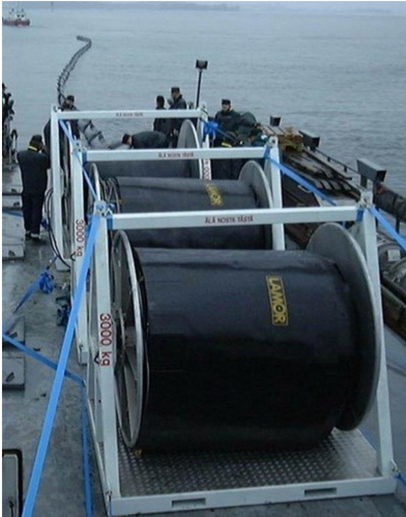
Kuva 1. Öljypuomia lasketaan aluksen kannelta
