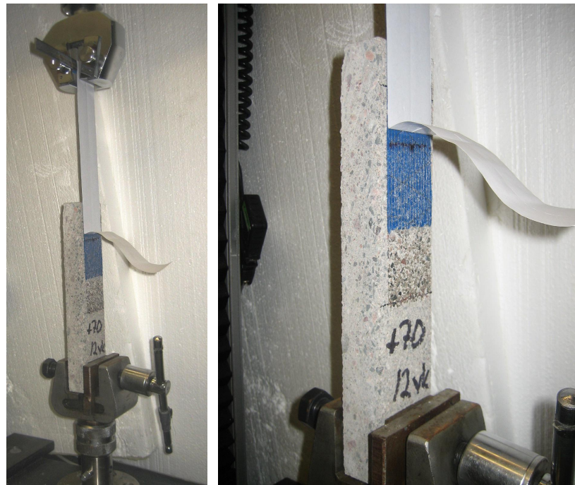
Kuva 2. Teipin peeling-veto, tartunta- alustana betonilaatta.
