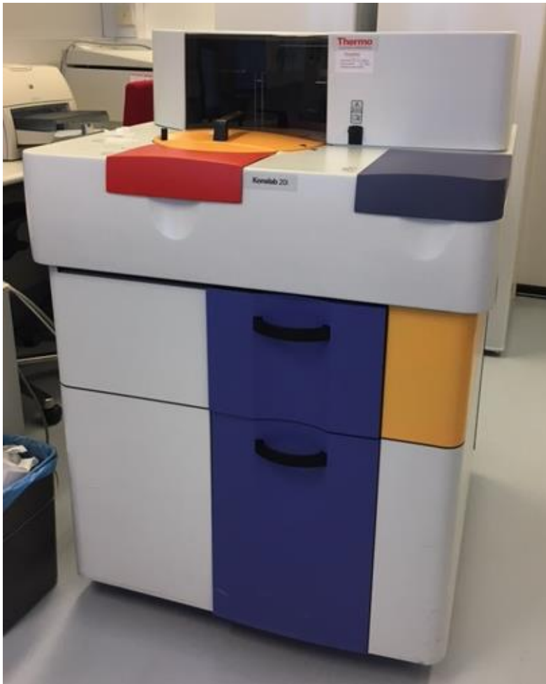
Kuvio 2. Kliininen kemian Konelab20i-analysaattori. Tässä analysaattorissa näytteet ladataan punaisen kannen alla olevalle näytekielelle, reagenssit ladataan reagenssikielelle, joka sijaitsee pyöreän keltaisen kannen alla. Kuvassa oikealla puolella olevan sinisen kannen alla on kyvettyyksikkö. Kuvassa kahdessa alla olevissa vetolaatikoissa on kyvettiroskakori sekä vesi- ja jätekanisteri. (Kati Kemppainen, Maria Oravala 2021.)
