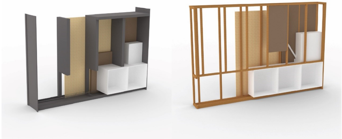
Kuva 8. Älyseinän ohutlevy- ja puurungon kehittyneemmät mallit (Eronen 2021)
