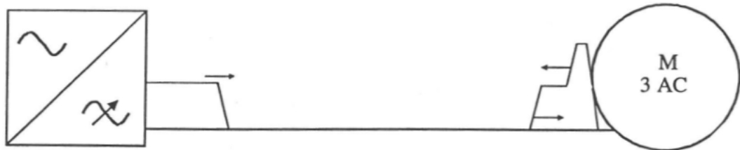
Kuva 11. Yhden kerran heijastunut jännitepulssi [7, s. 7].
