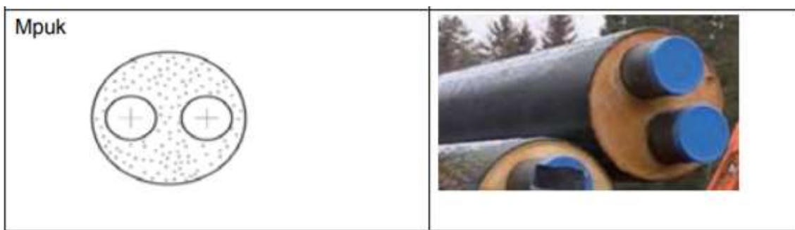
KUVA 2 Mpuk-kaukolämpöelementti (Mäkelä & Tuunanen 2015, 57.)
