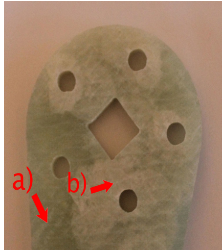
Figur 15. Glasfiberskiva skuren med abrasiv vattenskärning. a) Helt, odelaminerat material. b) Delaminerat material (Petter Selenius)
