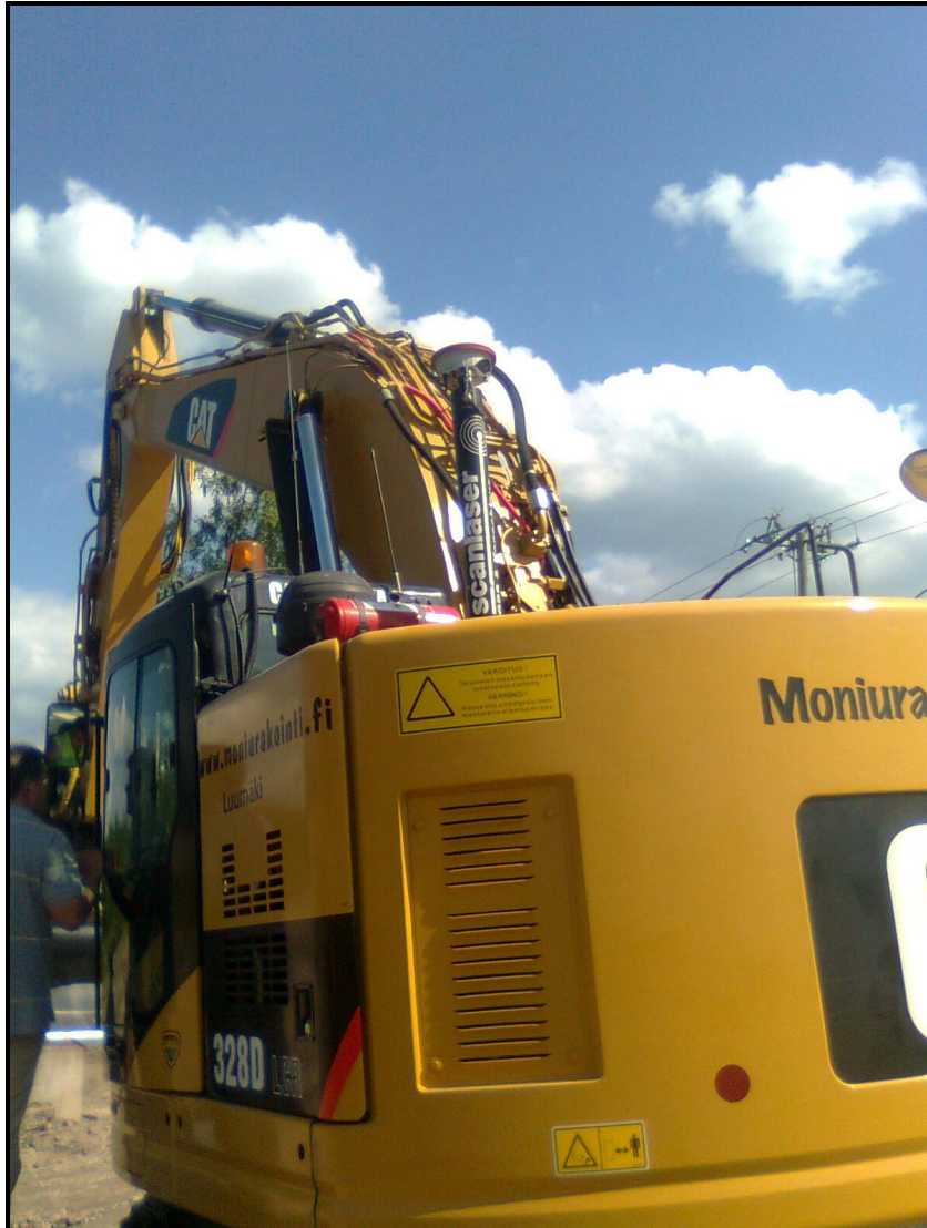
kuva 8. GPS-antenni kaivukoneen peräpuntissa
