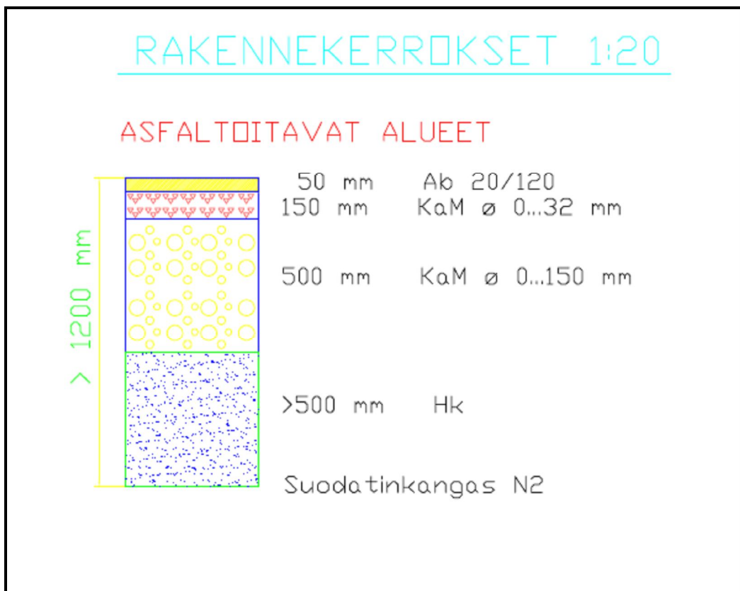
Kuva 12. Kentän rakennekerrokset.
