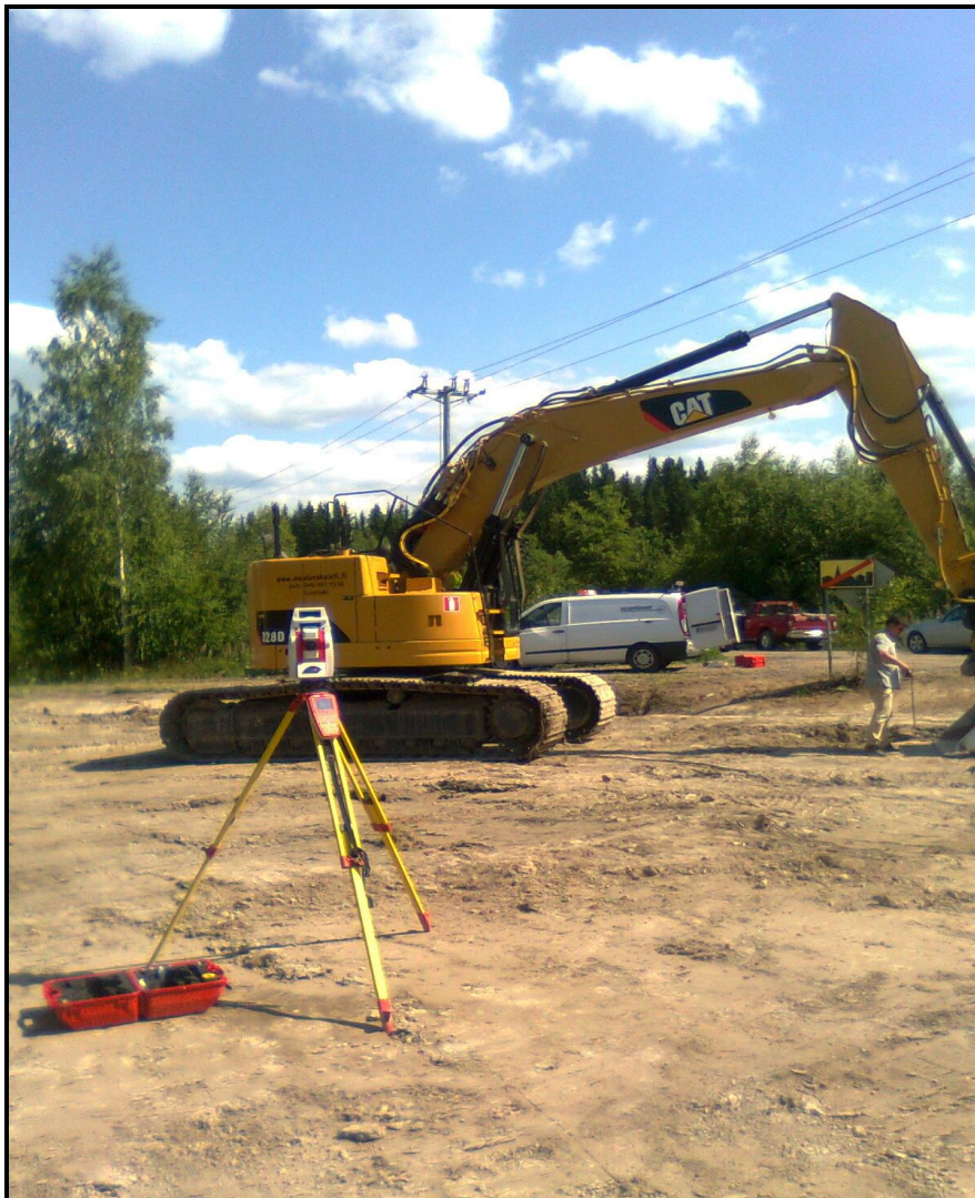
Kuva 10. Puomiston ja antennien linjausmittaus robottitakymetrillä.
