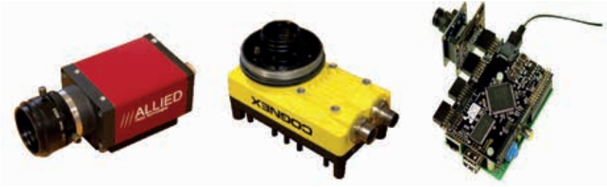
Kuva 1. Konenäkökamera (vas.), älykamera (kesk.) ja FPGA-pohjainen sulautettu kamerajärjestelmä (oik.) (SAMK automaation tutkimusryhmä, [viitattu: 12.8.2020]; Element14 2014).
