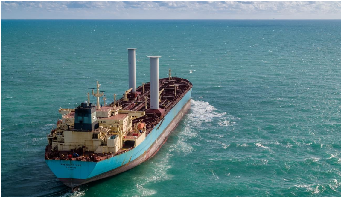
Kuva 1 Kaksi 30 X 5 metristä roottoripurjetta operoivat Maersk Pelicanin kannella (Norsepower 2020)
