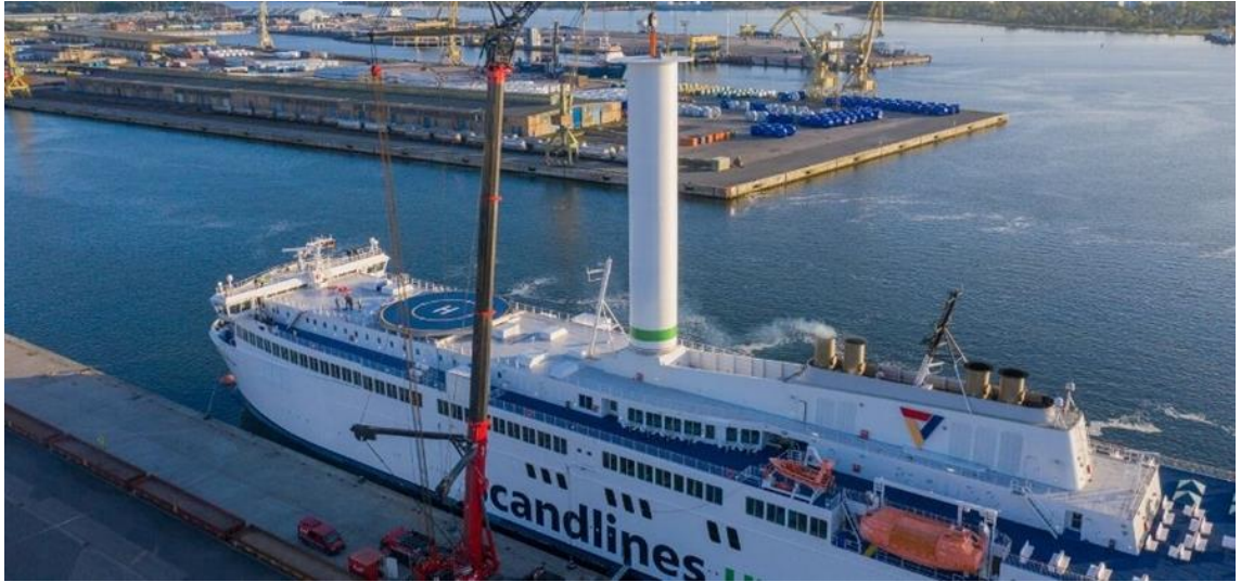
Kuva 3 Uusimman 30 x 5 metrisen roottoripurjeen asennus Scandlines Copenhagenille (Cruise and Ferry 2020)
