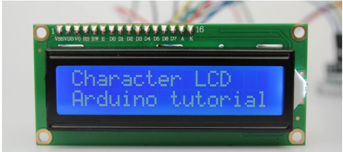
Kuva 15 Nestekidenäyttö kytkettynä Arduinolle (Makerguides 2020)
