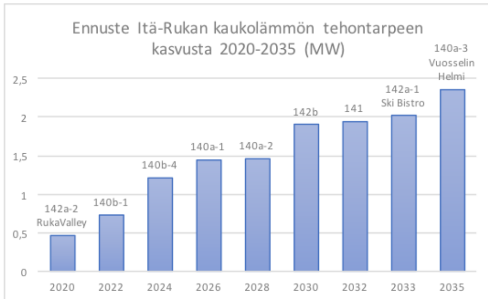
KUVA 29. Viidentoista vuoden ennuste Itä-Rukan kaukolämmön tehontarpeen kasvusta
