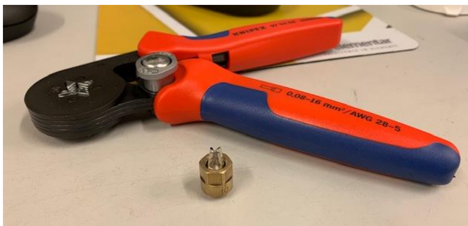
KUVA 4. Kiinni puristettu nikkelikapseli ja puristustyökalu
