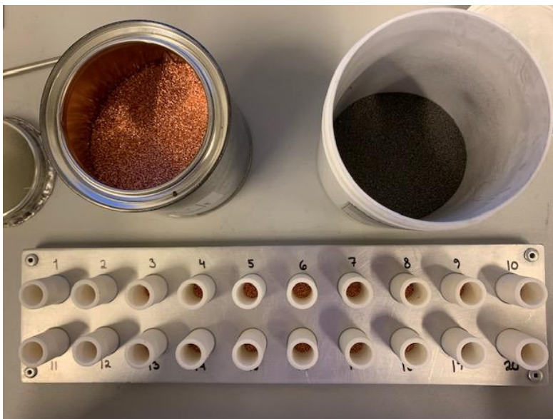
KUVA 3. Hiilipitoisuusanalyysissä käytettävät keraamiset upokkaat sekä kiihdytinaineet kupari ja volframitina
