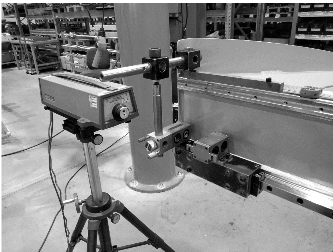
Kuvio 21. Johdekelkkojen kulkulinjan suoruuden mittaus
