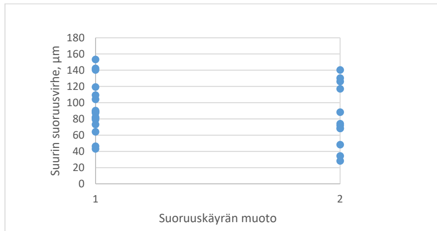
Kuvio 29. Suoruskäyrän muodon ja suurimman suoruuksvirheen regressioanalyysi
