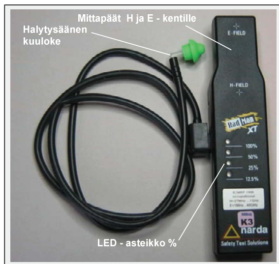
KUVIO 20. Henkilökohtainen hälytin ja altistumismittari (Narda ESM-30, XT)
