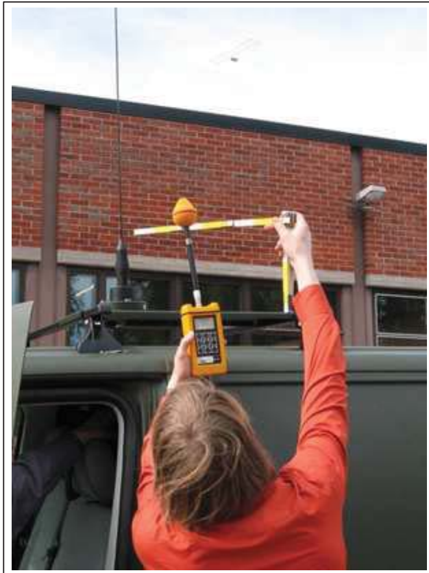
KUVIO 21. Radiojärjestelmän säteilyturvallisuuden mittaustapahtuma
