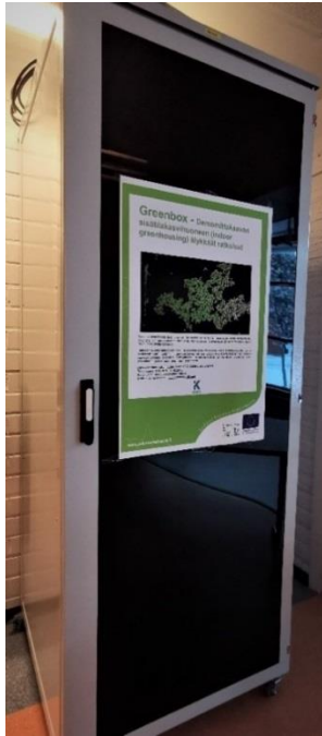
Kuva 1. Vanhasta palvelinkaapista tehtiin kasvatuskaappi.
