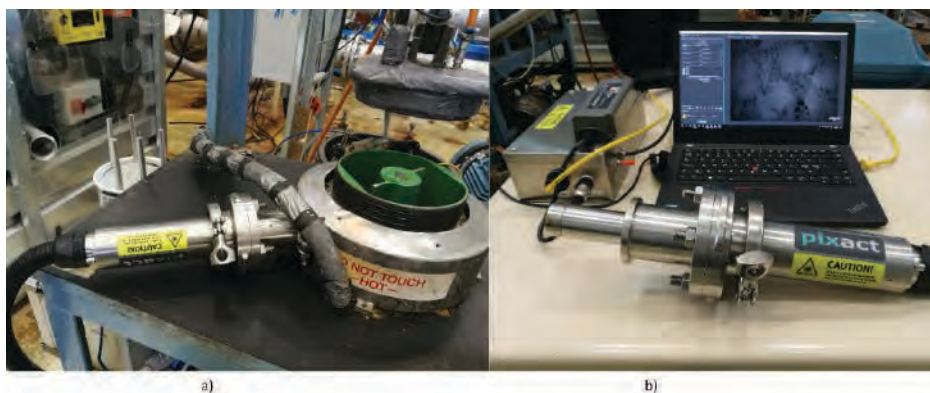
KUVA 1. Kuvassa 1a nähdään Pixact Oy:n kuplakuvausjärjestelmän kuvauspää asennettuna Mark-reaktorin kylkeen. Kuvassa 1b on esitetty koko kuplakuvausjärjestelmä tietokoneineen (kuva Antti Pappinen).
