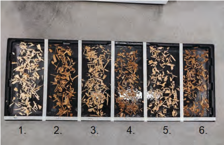
KUVA 2. Koeasetelma liukkaudentorjunnan testaamiseen. Tummat lastut lämpökäsiteltyjä. Koesarjat 1-2: käsittelemättömät kontrollilastut, koesarjat 3-4: magnesiumkloridilla käsitellyt lastut, koesarjat 5-6: kalsiumkloridilla käsitellyt lastut (kuva Lasse Hämäläinen).
