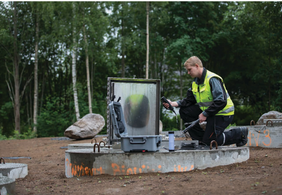
KUVA 1. Huky-hankkeessa käytetään online-anturiteknikkaa hulevesien laadun seurannassa (kuva Manu Eloaho).
