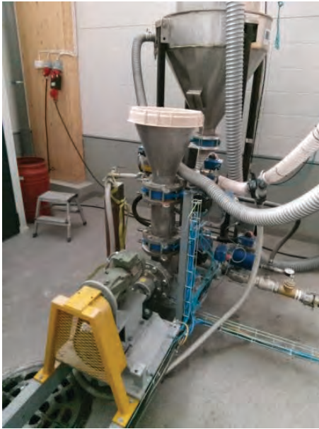
KUVA 1. Koeajoissa käytetty pilot-mittakaavan mikronisointi- ja luokittelulaitteiston syöttösuppilo (edessä) sekä hienotuotesäiliö (takana) (kuva Eveliina Kuokkanen).
