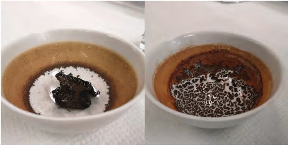
KUVA 1. Vasemmalla on kuivattua MBR-lietettä ja oikealla kuivattua aktiivilietettä (kuvat Jussi Konttila).
