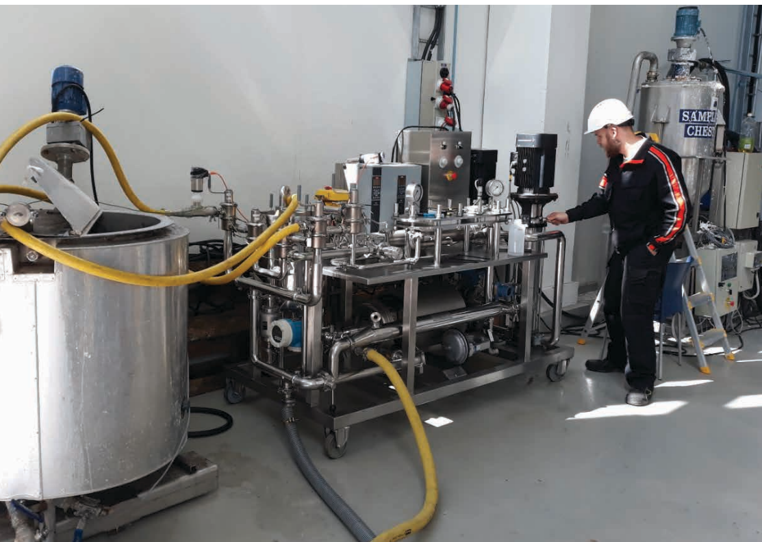
KUVA 1. Ultrasuodatuslaitteisto kokonaisuudessaan. Vasemmalla lämmitettävä prosessiliuoksen syöttösäiliö ja oikealla suodatuslaitteisto (kuva Kari Kärkkäinen).
