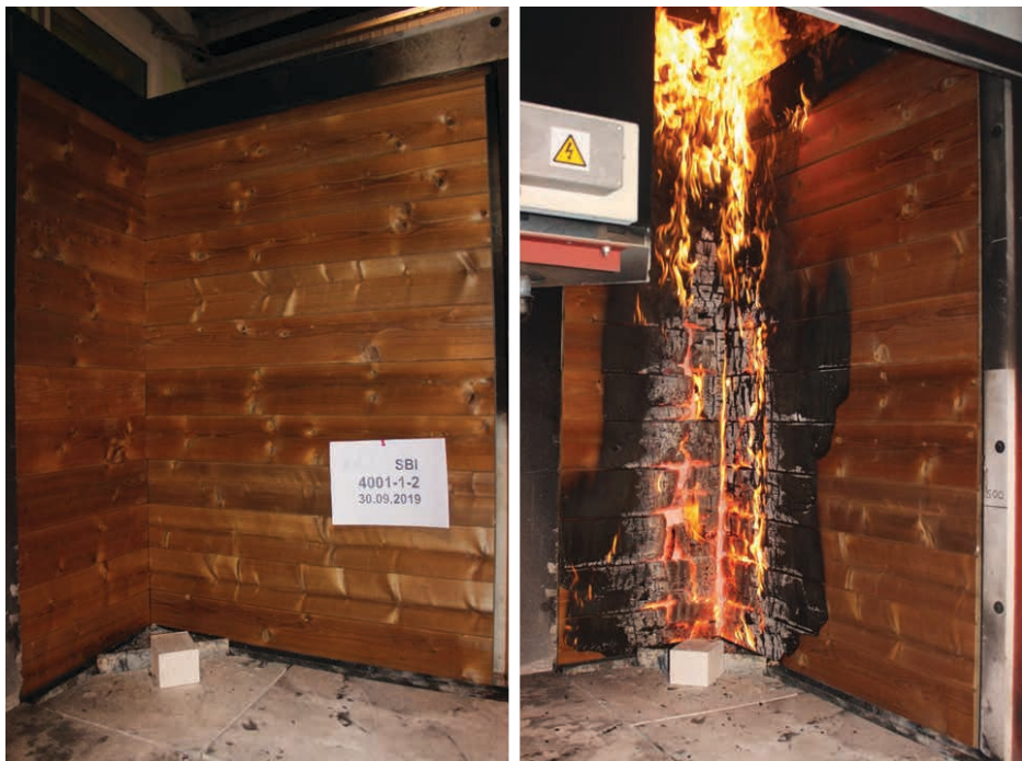
KUVA 3. SBI-koe: koemateriaalit asennettuna vaakaan (kuvat Edgars Bukšāns).
