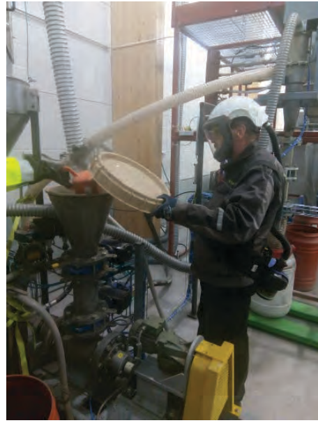
KUVA 2. BioSammon laitosvastaava Juha Solio pitämässä syöttösuppilon kantta samalla, kun kehitysinsinööri Teemu Karttaavi lisää biolentotuhkaa laitteistoon. Kansi vähentää tuhkan pölyämistä hallitilaan (kuva Eveliina Kuokkanen).
