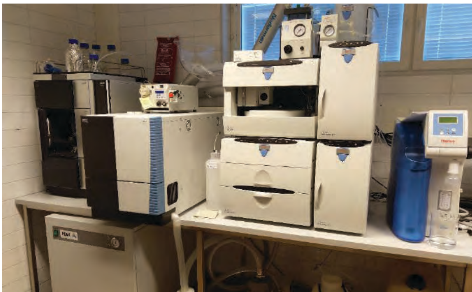
KUVA 2. Kuitulaboratorion kromatografilaitteistot. Osat vasemmalta oikealle: HPLC, MS, IC ja puhdasvesigeneraattori (kuva Jenna Raunio).
