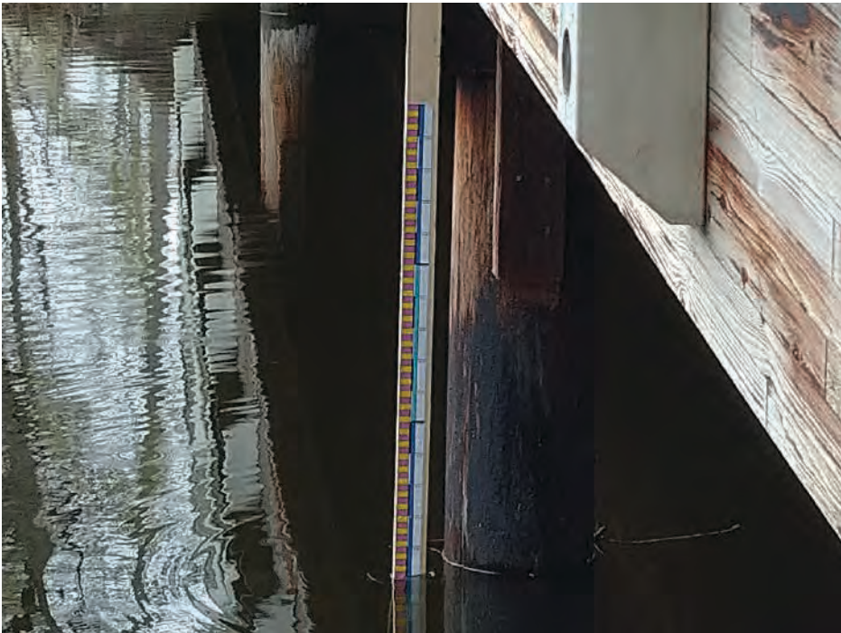
KUVA 1. Mittatikon 1. prototyyppi Urpolanlammella (kuva Tero Jankko).
