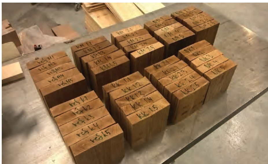
KUVA 1. Palosuojattuja ja suojaamattomia kartiokalorimetrinäytteitä (kuva Juho Peura).
