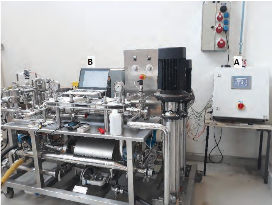
KUVA 3. Oikealla Xamkin tiedonkeruulaite (A), jonka päällä vasemmalla näkyy 3G-antenni. Suodatuslaitteiston päällä on kannettava tietokone (B), jossa on näkyvillä kaikki mitatut mittaustiedot toteutettuna langattomilla tiedonsiirtoyhteyksillä Xamkin koelaitteesta ANDRITZ Metris IIOT-järjestelmään (kuva Kari Kärkkäinen).
