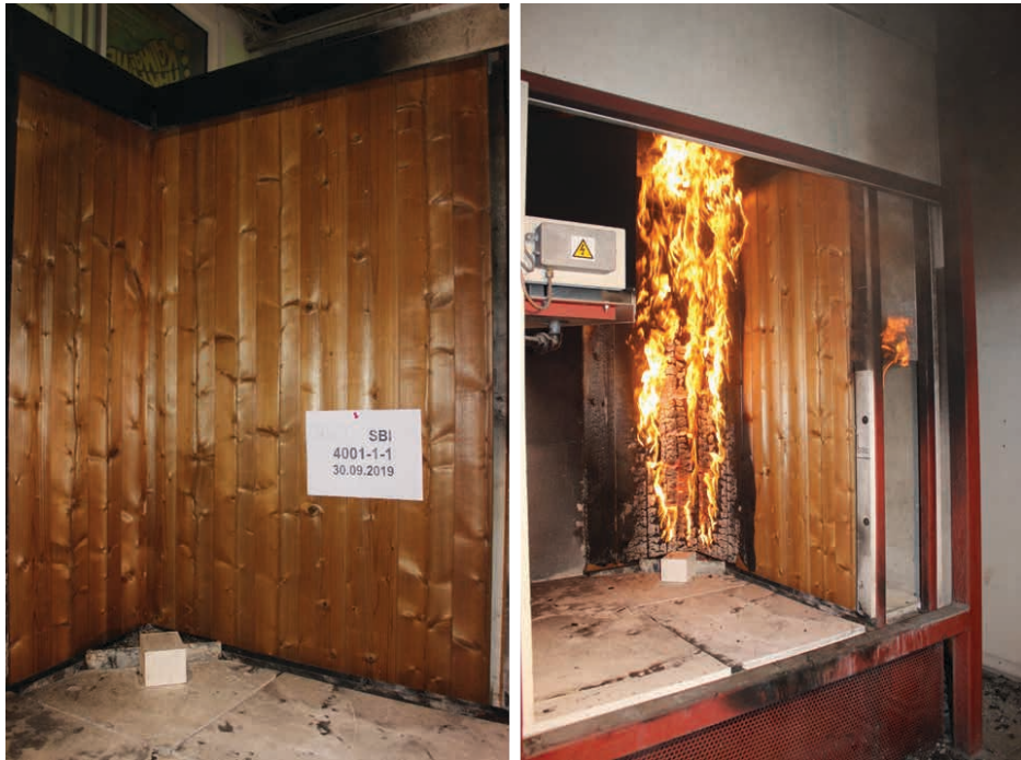
KUVA 2. SBI-koe: koemateriaalit asennettuna pystyyn (kuvat Edgars Bukšāns).
