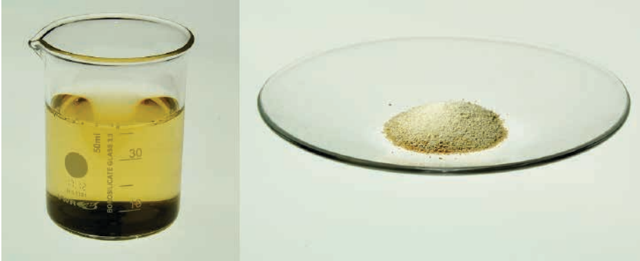
KUVA 5. Vasemmalla suodatettu uute. Oikealla etanolisaostettu, suodatettu ja kuivattu uute (kuva Mari Rasku).
