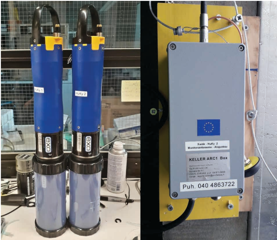
KUVA 3. EXO 3 -vedenlaatusondit (vasen) sekä ARC-1 Box -lähetinyksikkö (oikea). Laitteiden välillä on 10 metriä pitkä datakaapeli (kuva Aki Mykkänen).
