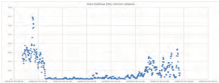
KUVA 5. Tunnistettujen kuplien määrän perusteella laskettu indikaatio jäännöskaasun määrästä reaktorin yläosassa (Käyhkö et al. 2019b).
