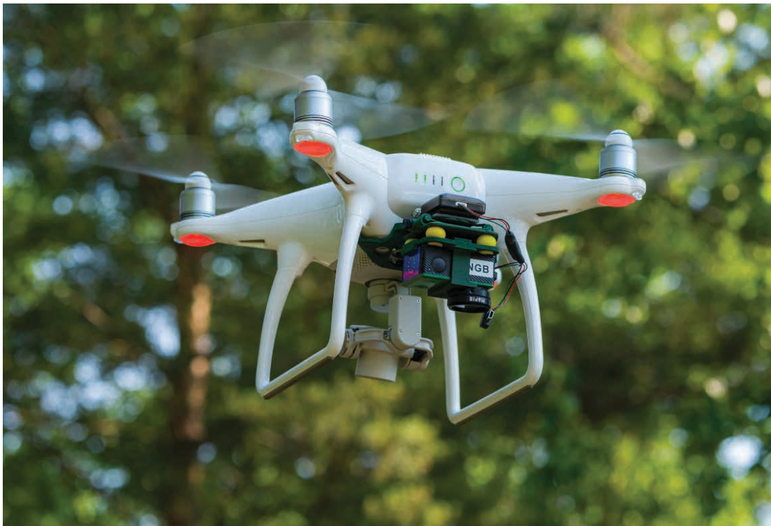
KUVA 1. Uumo-hankkeessa käytetään DJI-Phantom 4 -droonia ja Mapir-multispektrikameroita (kuva Aki Mykkänen).
