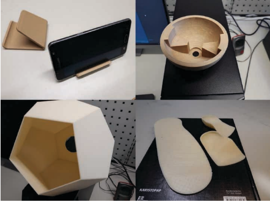
KUVA 3. Vasemmalla ylhäällä kännykkätelineitä ja oikealla ylhäällä LED-kotelon kansiosa Colorfabbin WoodFillistä. Vasemmalla alhaalla lampunvarjostin UPM Formi 3D:stä ja oikealla alhaalla pohjallisia joustavasta biohajoavasta WillowFlex-materiaalista (sis. mm. PBS:ää eli polybutyleenisukkinaattia) (kuva Ilkka Vanttaja).
