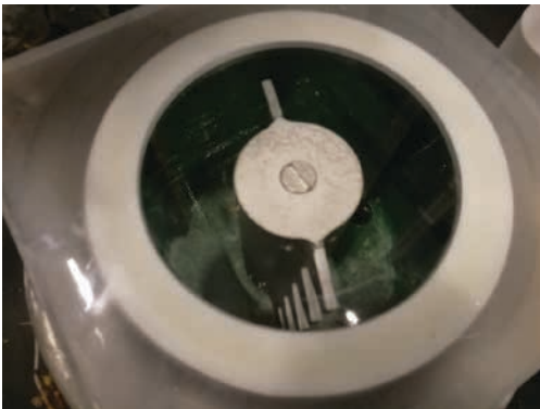
KUVA 4. Mark-reaktoriin tehtiin läpinäkyvä kansi käytettäväksi sekoituksen haittatankojen kanssa. Materiaalina akryyli (kuva Antti Pappinen).
