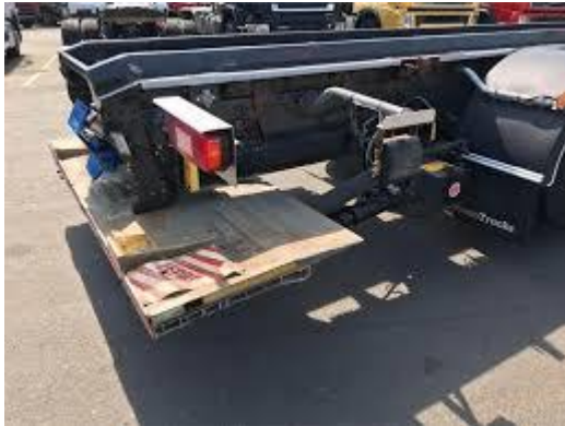
Kuva 11. Alle taittuva takalaitanostin (Suvanto trucks)
