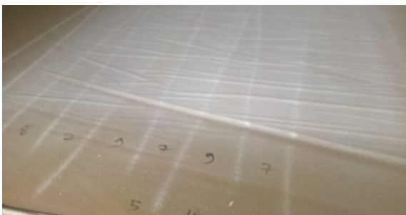
Kuva 10. Yhden pistoolin levitys hajotusilmalla.
