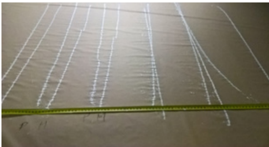
Kuva 9. Yhden pistoolin viuhkan piirtojälki matolla, veto ja työntö, ilman hajotusilmaa
