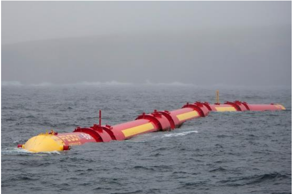
Kuva 8. Pelamis P2 -aaltoenergia-laite (Pelamis Wave Power 2011)
