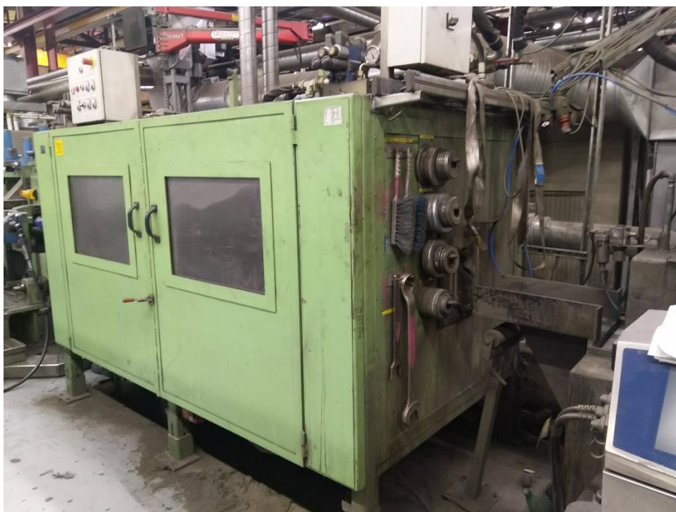
Kuva 4. Putken harjausvaiheen kotelointi
