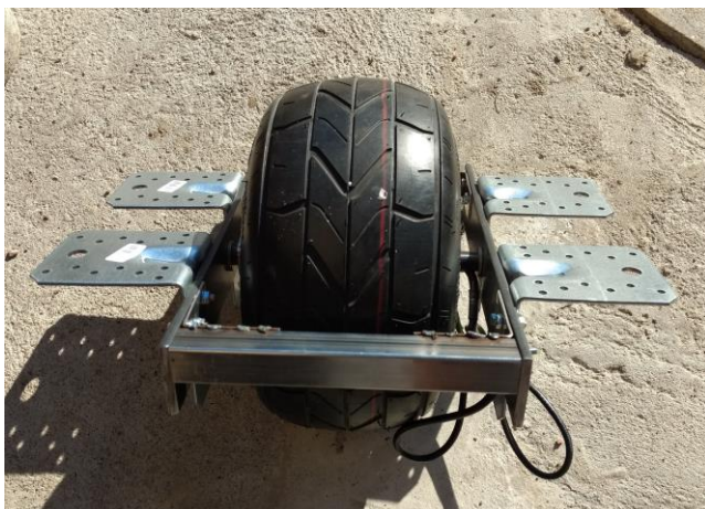
Kuva 18. Ajoneuvon runko. Napamoottori on kiinnitetty akselinsa varaan runkoon.
