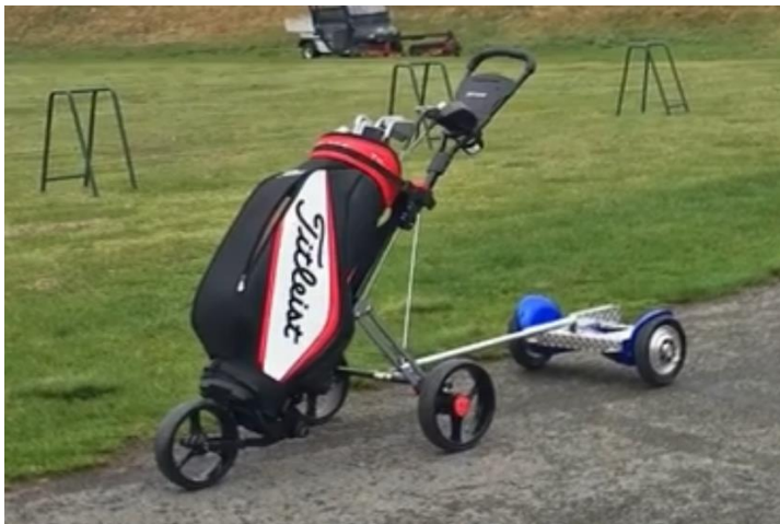
Kuva 5. Sähköisen tasapainolaudan kiinnitys golfkärryyn (8, s 1).
