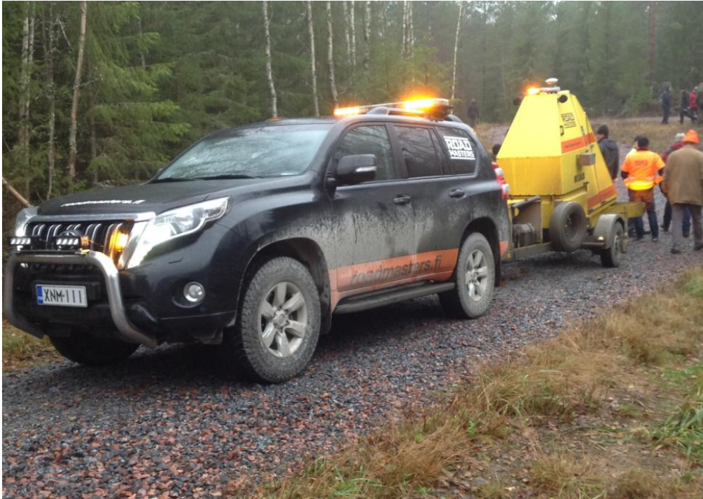
KUVIO 11. Kantavuusmittaus KUAB FWD 50 -pudotuspainolaitteistolla (Nousiainen 2018)
