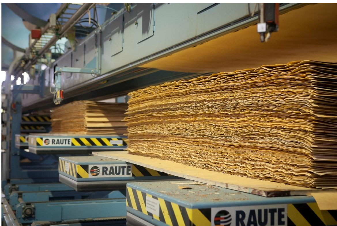
Kuva 8. Brianskin tehdas tekee viiluista vaneria (Lepistö 2011)
