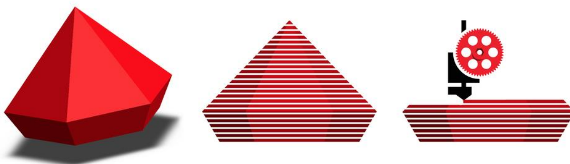
Kuva 3. 3D objektin kerroksittain rakentaminen (Cura 2019)
