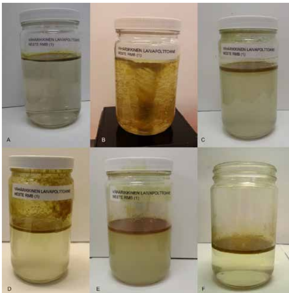
Kuva 7. Vähärikkisen laivapolttoaineen Neste RMB:n käyttäytyminen makeassa vedessä: a) 1 vrk: 5 minuuttia öljyn lisäämisen jälkeen, b) 1 vrk: magneettisekoituksessa, c) 2 vrk: 5 minuuttia 24 tunnin magneettisekoituksen jälkeen d) 3 vrk: 5 minuuttia 24 tunnin magneettisekoituksen jälkeen +5 °C:ssa, e) 14 vrk: 5 minuuttia 12 vuorokauden ravistelijassa sekoituksen jälkeen, f) 21 vrk: haihtunut kansi auki vetokaapissa viikon. Kuvat: Mariia Zhaurova 2016, Malk & Zhaurova 2017, 221.
