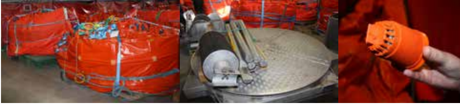
Kuva 7. Itsetäyttyvää expandipuomia. Valmistajan mukaan puomin vakavuus riittää vielä 15 metriä sekunnissa -tuulella, kahden metrin aallokossa ja kolmen solmun (1,5 m/s) virtauksessa. Kuvat: Mikko Pitkäaho 2017.
