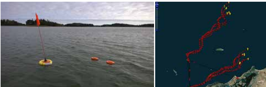
Kuva 21. Paikkatietosignaalia lähettävien ajelehtimispoijujen avulla torjuntatöiden johto pysyy tietoisena öljyn kulkeutumisesta myös pimeällä. Kuvat: Purokoski, Ilmatieteen laitos 2014 ja Fastwave.
