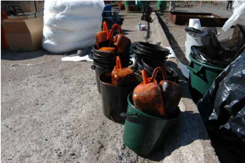
Kuva 21. Torjunta- ja keräystyö tuottaa paljon öljyistä sekajätettä. Välineitä ja tarvikkeita tulee mahdollisuuksien mukaan puhdistaa ja käyttää uudelleen. Kuva: Melinda Pascale 2011.
