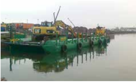
Kuva 3. Työkoneiden lautta- ja proomukuljetukset saattavat mahdollistaa myös työskentelyn veden puolelta, mikäli koneen ulottuvuus ja rannan profiili sallivat. Esimerkiksi kalliojyrkänteiden pesu on turvallisempaa lautalta käsin. Kuvat: Kuormaustyö KM Oy.
