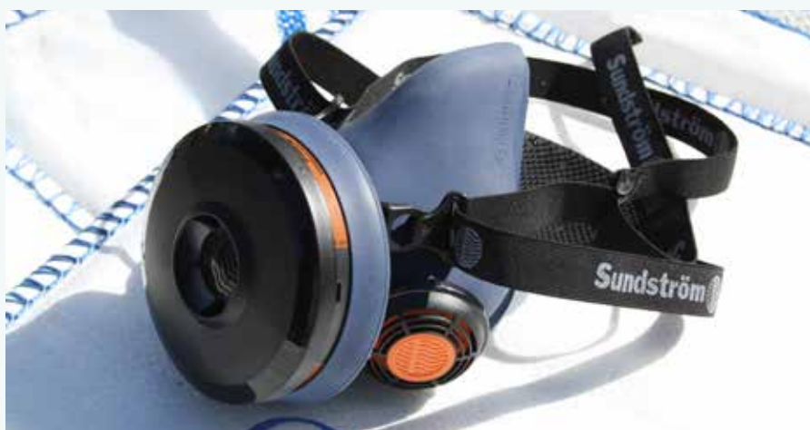
Kuva 1. Suojain- ja suodattintyyppi valitaan riskinarvioinnin perusteella. Kyseinen kevyt kaasusuodatin SR 217 A1/SR 218 A2 soveltuu sisävesien torjuntatyöhön, jossa vahinkoaine on todennäköisesti kevyttä polttoöljyä eikä kemikaaleja ole odotettavissa. Merialueella varaudutaan myös raakaöljyn torjuntaan, ja suojaimeksi on hankittu ABEK-suodattimilla varustettuja suojaimeja. Kuva: Justiina Halonen 2018.
