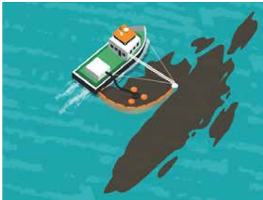
Kuva 17. Keräystä yhdellä aluksella laitakerääjän (vasemmalla) ja paravaanin avulla (oikealla). Keräysjärjestelmissä on tyypillisesti kiinteät keräimet, mutta puomin pohjukassa voidaan kuljettaa myös kelluvaa keräintä. Kuvat: IPIECA-IOGP 2015.
