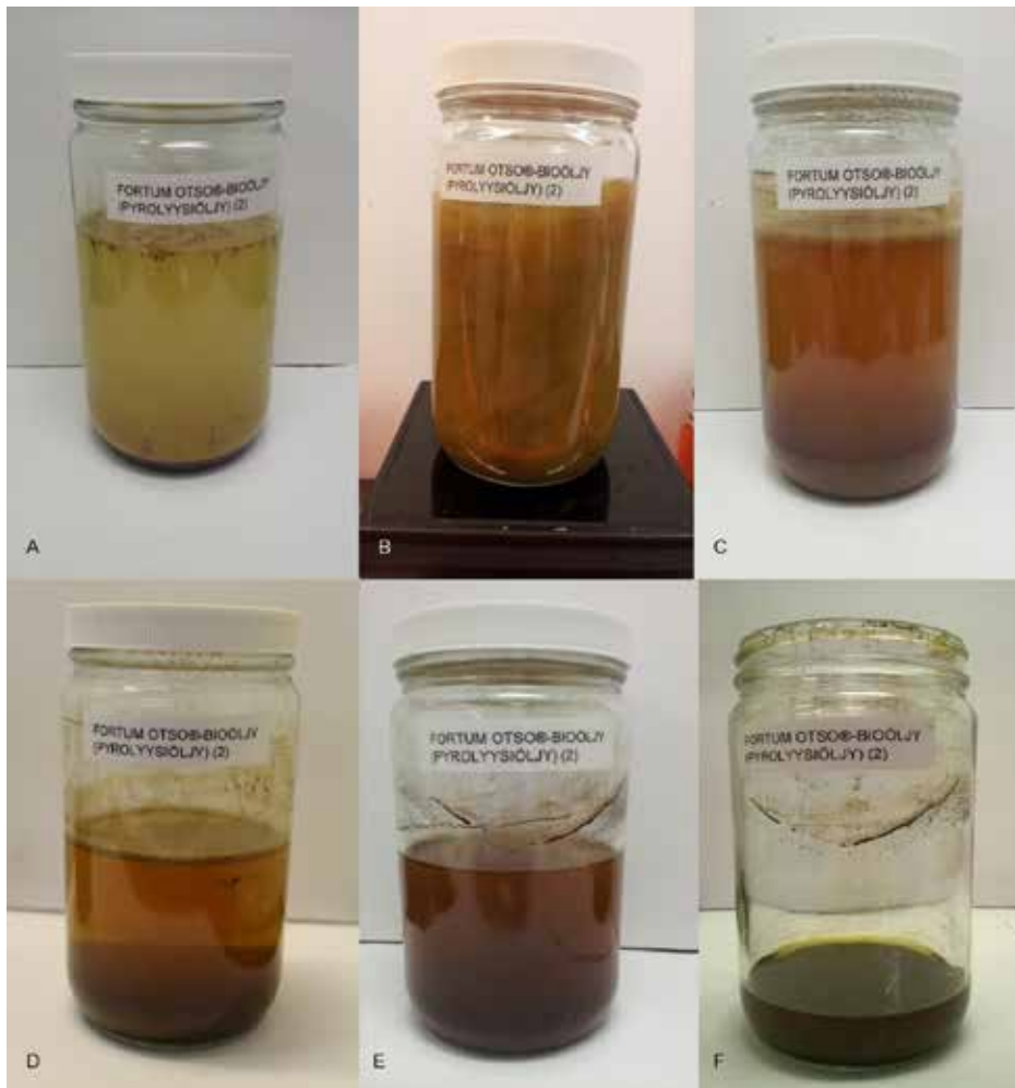
Kuva 11. Pyrolyysiöljyn Fortum Otso käyttäytyminen makeassa vedessä: a) 1 vrk: 5 minuuttia öljyn lisäämisen jälkeen, b) 1 vrk: magneettisekoituksessa, c) 2 vrk: 5 minuuttia 24 tunnin magneettisekoituksen jälkeen d) 3 vrk: 5 minuuttia 24 tunnin magneettisekoituksen jälkeen +5 °C:ssa, e) 14 vrk: 5 minuuttia 12 vuorokauden ravistelijassa sekoituksen jälkeen, f) 21 vrk: haihtunut kansi auki vetokappissa viikon. Kuvat: Mariia Zhaurova 2016, Malk & Zhaurova 2017, 223.
