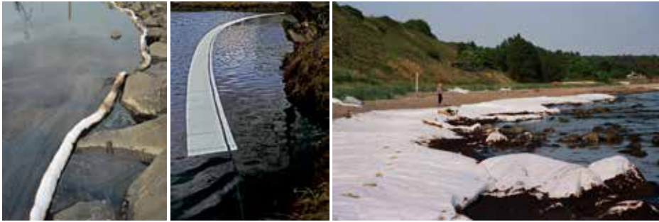
Kuva 32. Pitkomaisten imeytyspuomin suojausteho on melko heikko: pyörähdellessään pitko päästää öljyn altaan, sillä puomissa ei ole helmaa, joka estäisi öljyn leviämisen. Nauhapuomi säilyttää kosketuksensa veteen aallokossakin, ja sen imeytyspinta-ala on laaja. Rannansuojamaton suojausteho on hyvä, mikäli matto saadaan aseteltua kivikkoon tiiviisti. Kuvat: Marko Hintsala, Knorring Oy Ab 2014, Etelä-Karjalan pelastuslaitos ja Sydöstra Skånes Räddningstjänst 2006.
