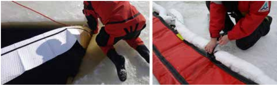
Kuva 16. Eri puomityyppien toimivuuden testausta jäänalaisen puomituksen teossa. Kuvat: Justiina Halonen 2018.
