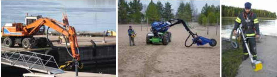
Kuva 6. Vasemmalla kaivukonesovitteen harjakeräin. Pehmeäpohjaisissa ja vaikeakulkuisissa maastoissa harjakauhan työalustana voidaan käyttää modifioitua Harveri-metsätyökoneen runkoa. Oikealla käsikäyttöinen rock cleaner. Kuvat: Justiina Halonen 2009, 2014 ja Suomen ympäristökeskus 2013.
