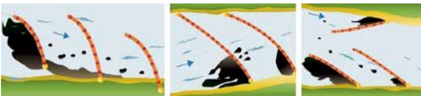
Kuva 23. Puomitus virtaavassa vedessä ketjupuomituksilla. Kuvat: Cedre.
