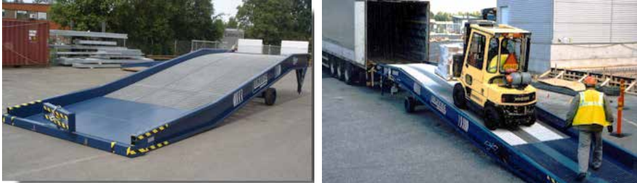
Kuva 2. Siirrettävien kuormaussiltojen käyttö. Kuvat: Lintec 2010.
