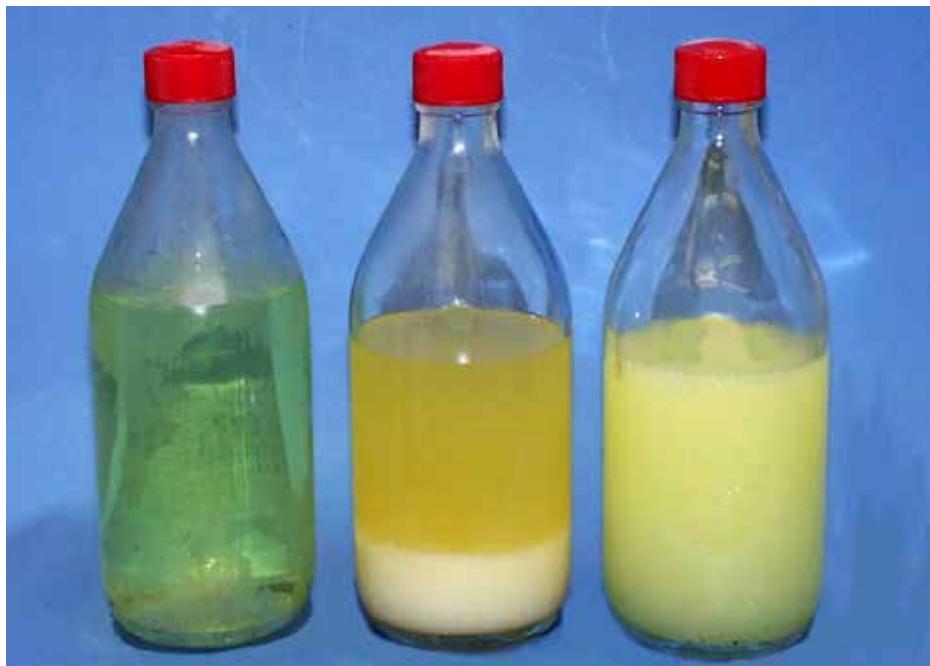
Kuva 4. Laivadieselin DMA- ja DMB-laatujen parafiinien kiteytyminen samepisteessä. Kuva: Tuukka Hartikka 2015, Halonen & Malk 2017, 241.
