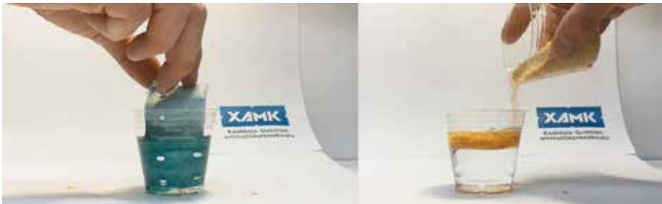
Kuva 4. SÖKÖSaimaa-hankkeessa laadittiin lyhyitä demovideoita, joissa havainnollistetaan raskaan polttoöljyn ja dieselin reaktioita eri torjuntamateriaalien, kuten imeytyspurun, imeytysmaton ja dispersanttien kanssa. Kuvat: Emmi Rantavuo 2017.
