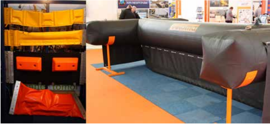
Kuva 4. Eri puomityyppejä. Vasemmalla pääasiassa aitapuoimia erilaisilla kellukkeilla, oikealla verhopuomirakenteinen avomeripuomi. Kuvat: Justiina Halonen 2015.
