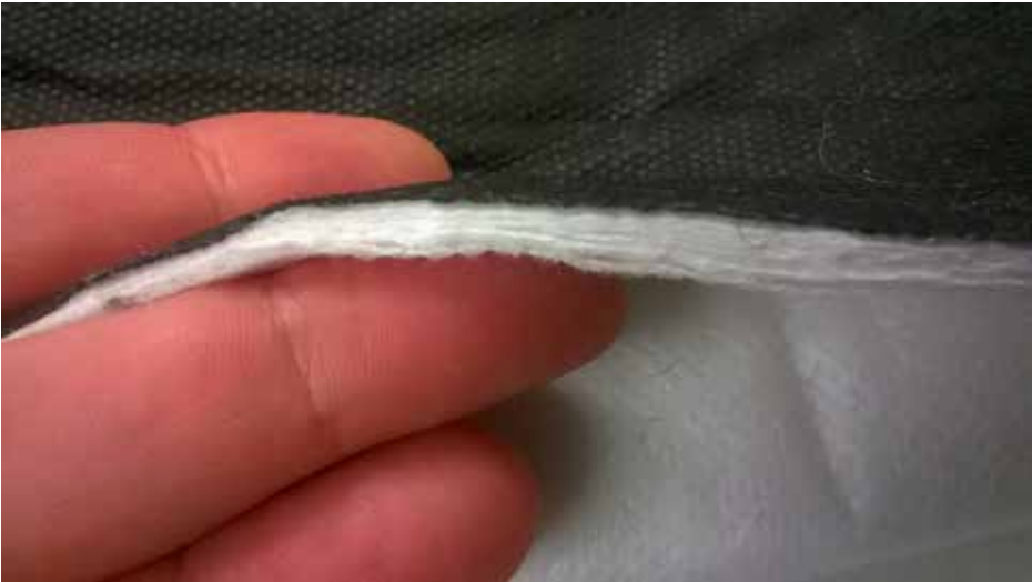
Kuva 7. Keräystyömaan suojaukseen käytettävää rannansuojamattoa. Tämä mattotyppi asennetaan musta puoli ylöspäin. Valkoiselta alapuolelta erottaa hyvin, milloin matto alkaa päästää läpi. Kuva: Justiina Halonen 2017.
