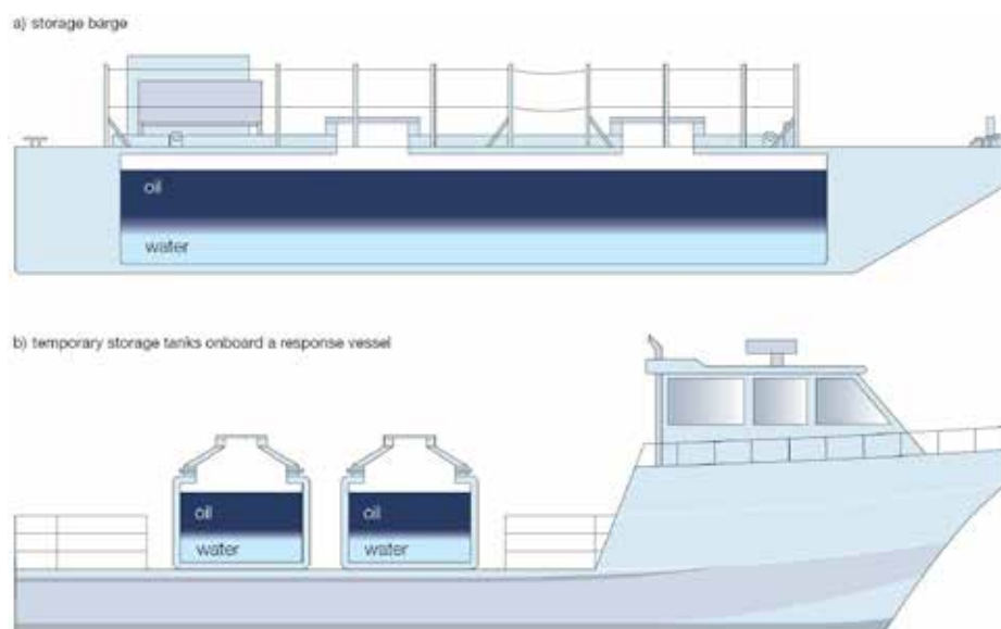
Kuva 9. Öljyn erottaminen seisottamalla kelluvassa keräyssäiliössä tai säiliöproomussa tai neste-mäisen jätteen keräyssäiliöissä. Kuvat: IPIECA & IOGP 2013, 2.
