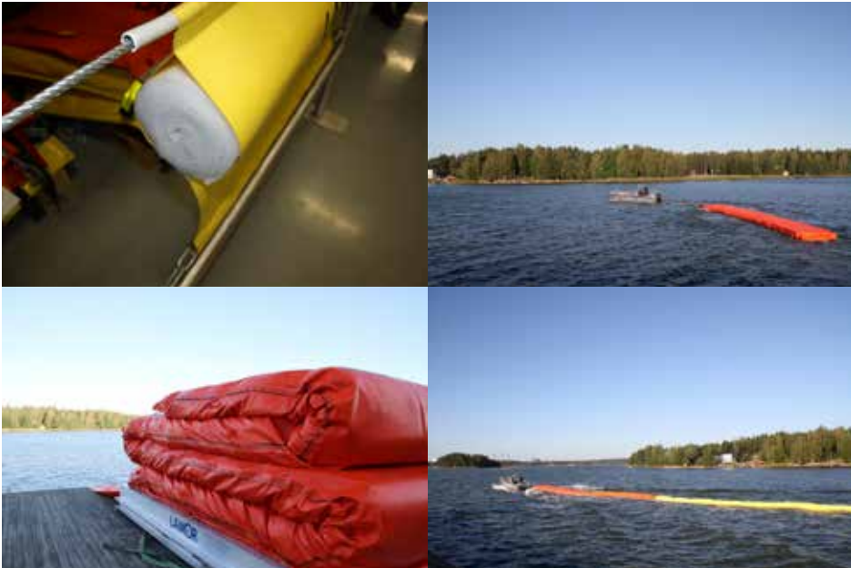
Kuva 8. Puomien nopeaa levittämistä varten on kehitetty erilaisia pikapuomitusjärjestelmiä. Kuvassa selvitetään pikapuomia, jossa on taipuisa solumuovikelluke. Kuvat: Lamor Corporation Ab ja Mikko Pitkäaho 2017.
