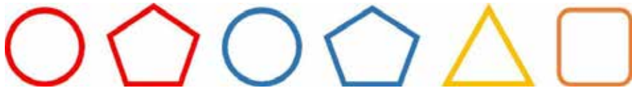
Kuva 1. Logististen pisteiden symbolit. Vasemmalta oikealle kuljetuspisteiden (K) neljä symbolia. Kuljetuspiste on merkitty punaisella ympyrällä silloin, kun sinne on maantieyhteys ja sinisellä, kun se on saavutettavissa vesitse. Viisikulmaisella "mökki"-symbolilla on eroteltu ne kuljetuspisteet, jotka sijaitsevat asutuksen läheisyydessä. Välivarastointipisteen (V) tunnuksena on keltainen kolmio, ja loppukäsittelypistettä (L) symboloi oranssi neliö. Kuvat: Elias Altarriba 2018.
