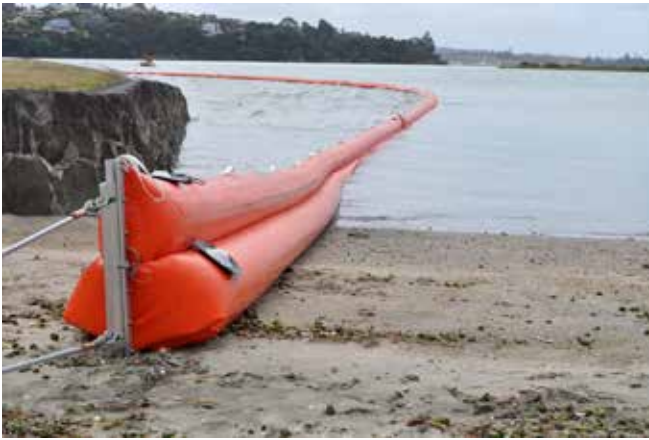
Kuva 10. Rannansuojapuomin rakenne ja toimintaperiaate. Puomia on pelastuslaitosten käytössä muun muassa Merenkurkussa ja Perämerellä. Ennen täyttämistä puomin paikka tulee miettiä valmiiksi, sillä täytettynä sitä on rannassa hankala miesvoimin siirtää. Kuva: Structurflex Limited.
