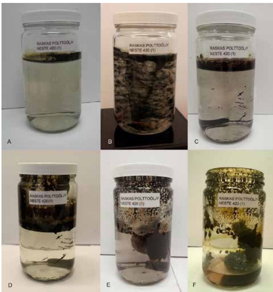
Kuva 9. Raskaan polttoöljyn Neste 420 käyttäytyminen makeassa vedessä: a) 1 vrk: 5 minuuttia öljyn lisäämisen jälkeen, b) 1 vrk: magneettisekoituksessa, c) 2 vrk: 5 minuuttia 24 tunnin magneettisekoituksen jälkeen d) 3 vrk: 5 minuuttia 24 tunnin magneettisekoituksen jälkeen +5 °C:ssa, e) 14 vrk: 5 minuuttia 12 vuorokauden ravistelijassa sekoituksen jälkeen, f) 21 vrk: haihtunut kansi auki vetokaapissa viikon. Kuvat: Mariia Zhaurova 2016, Malk & Zhaurova 2017, 219.
