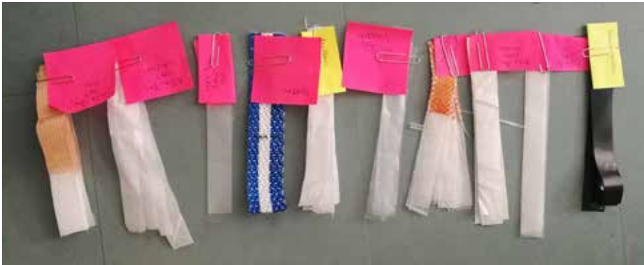
Kuva 2. Materiaalinäytteet öljyvahinkojätteen välivarastointiin tarkoitetuista välivarastointi- ja keräyssäkeistä. Kuva: Mikko Pitkäaho 2018.
