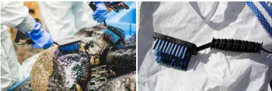
Kuva 3. Öljynkeräystä tarkoitukseen kehitetyillä harjoilla. Kuvat: Sajakorpi Oy ja Justiina Halonen 2018.
