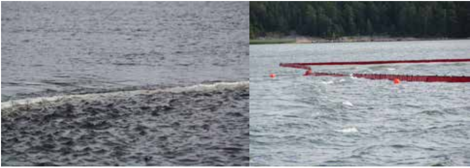
Kuva 21. Suurissa virtausnopeuksissa puomit tulee asettaa kulmaan vedenvirtaussuuntaan nähden, mikä vähentää puomiin kohdistuvaa suhteellista virtausnopeutta. Puomien toimintavarmuus saattaa heiketä myös aallokossa. Kuvat: Justiina Halonen 2017 ja Mikko Pitkäaho 2017.
