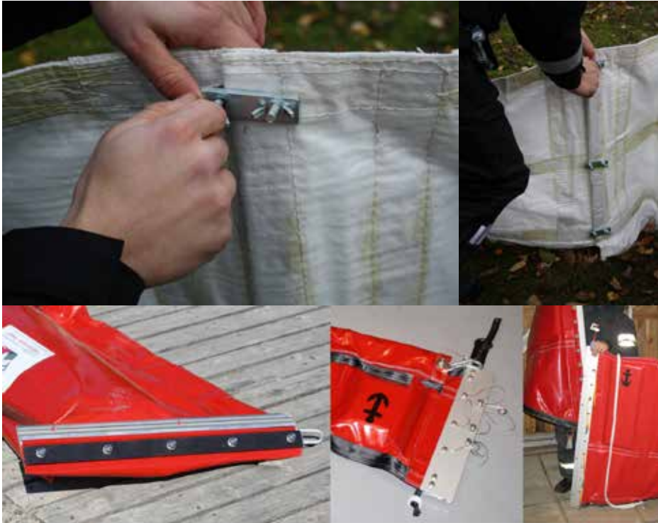
Kuva 2. Erilaisia puomiliittimiä. Ylä- tai alakautta liu'utettavan liukuliitoksen ja Z-liitoksen lisäksi käytössä on muun muassa U-pulttiliitoksia aluslevyllä ja siipimuttareilla. U-pulttiliitos tulee kiinnittää valmiiksi ennen veteen laskua. Toisissa liitintyypeissä on uros- ja naaraspuolet puomin eri päissä, ja tämä tulee huomata liitettäessä useampaa puomijataa yhteen vedessä. Kuvat: Justiina Halonen 2009, 2016 ja 2017.
