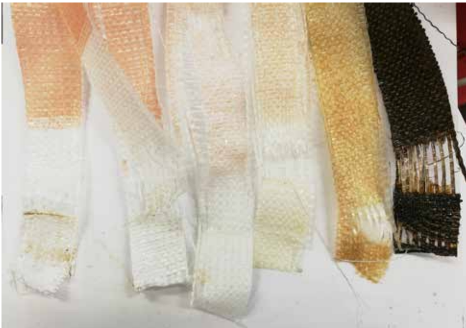
Kuva 20. Näytemateriaaleja vetotestin jälkeen. Kuva: Mikko Pitkäaho 2018.
