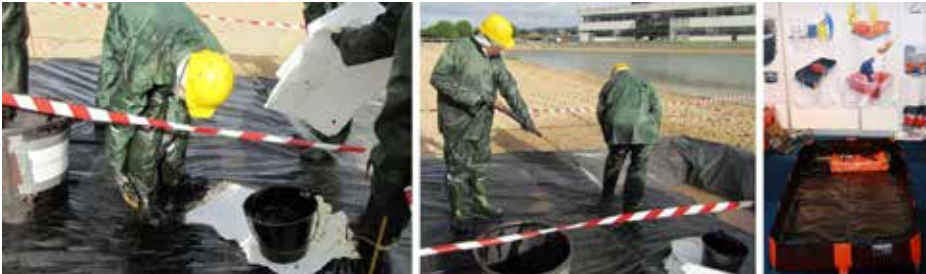
Kuva 15. Puhdistautumiseen voidaan käyttää imeytysarkkeja tai pesua. Pesu soveltuu, jos pesuvesien talteenotto on järjestettävissä. Vesille voidaan kaivaa keruukuoppa, josta ne johdetaan hallitusti. Puhdistautumispisteeksi soveltuvat kuitenkin paremmin pohjaveintiilillä varustetut tilapäisaltaat, jotka ovat sen verran matalia, että niihin on helppo kiivetä. Kuvat: Melinda Pascale 2010 ja Justiina Halonen 2015.
