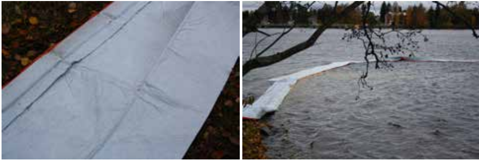
Kuva 10. Yhdentyypistä nauhapuomia kokeiltiin Imatralla vesistössä, jossa veden virtausnopeus oli suuri. Puomi myötäili aaltoa hyvin, mutta tuuli pyrki nostamaan kevyempää reunaa ylöspäin. Kuvat: Justiina Halonen 2017.
