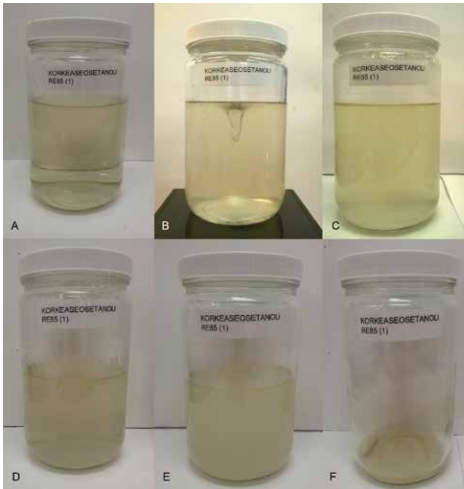
Kuva 12. Korkeaseoetanolin E85 käyttäytyminen makeassa vedessä: a) 1 vrk: 5 minuuttia öljyn lisäämisen jälkeen, b) 1 vrk: magneettisekoituksessa, c) 2 vrk: 5 minuuttia 24 tunnin magneettisekoituksen jälkeen d) 3 vrk: 5 minuuttia 24 tunnin magneettisekoituksen jälkeen +5 °C:ssa, e) 14 vrk: 5 minuuttia 12 vuorokauden ravistelijassa sekoituksen jälkeen, f) 21 vrk: haihtunut kansi auki vetokappissa viikon. Kuvat: Mariia Zhurova 2016, Malk & Zhurova 2017, 217.
