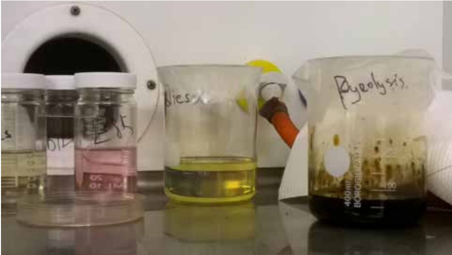
Kuva 10. Biopolttoaineilla ja uusiutuvilla polttoaineilla on huomattavia keskinäisiä ominaisuuksia. Kuvan polttoaineet ovat vasemmalta oikealle lueteltuina NExBTL, korkeaseosetanoli E85, petrodiesel ja pyrolyysiöljy. Kuva: Justiina Halonen 2016.
