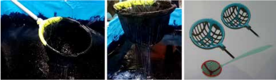
Kuva 4. Öljyn keräämiseen veden pinnalta kehitetty kuoppa, jossa kahden muovisen ristikkopohjaisen kappaleen väliin asetetaan imeytysarkki. Kuoppaa (scooper) saa myös yhdeltä sivultaan taiseksi muotoiltuna, jolloin sitä voidaan liikuttaa rantavedessä hyvin lähellä pohjaa. Imeytysarkki päästää veden lävitseen öljyn jäädessä kuoppaan. Kuvat: Justiina Halonen 2018.
