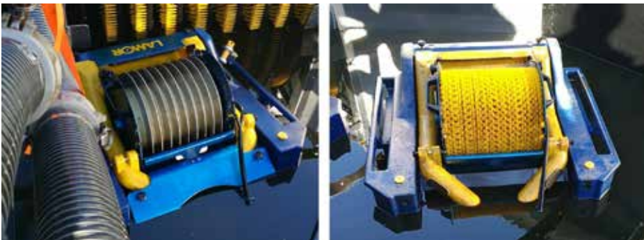
Kuva 8. Minimax-skimmeri kiekko- ja harjakeruuyksiköillä. Kuvat: Joel Kauppinen 2016.
