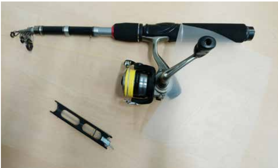
Kuva 28. Näytteenottovälineet eli ETFE-verkko, joka kiinnitetään verhonipsulla virvelin siimaan. Jos vahinkoalue on vaikeasti saavutettavissa, verkon voi kiinnittää myös RPAS-kopteriin. Kuva: Justiina Halonen 2018.
