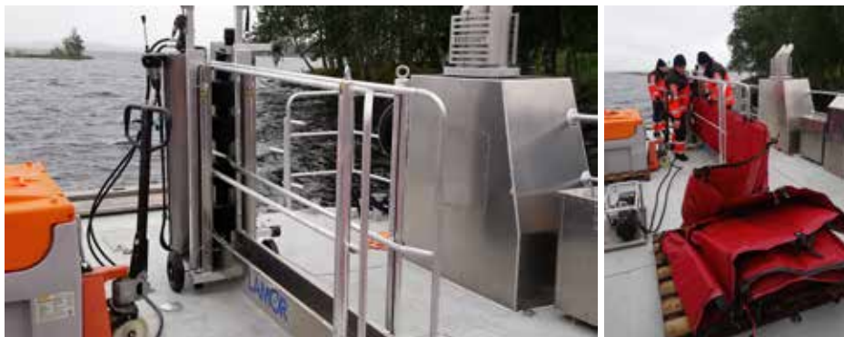
Kuva 36. Puominostoon on käytettävissä myös apuvälineitä, kuten tämä Kymenlaakson pelastuslaitoksella suunniteltu puominnostolaite. Kuvat: Justiina Halonen 2017.
