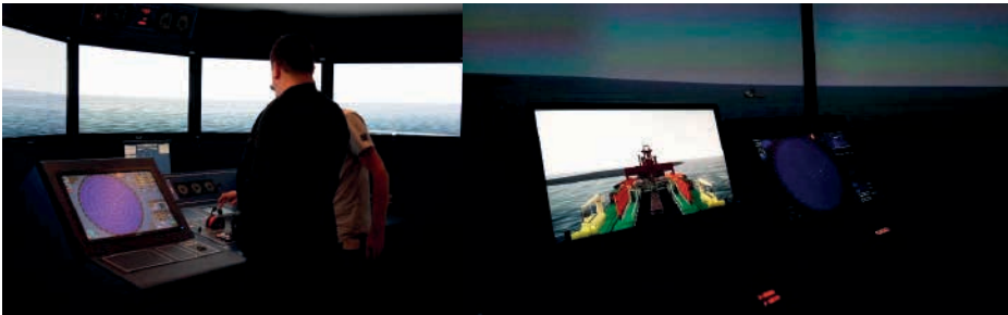
Kuva 3. Näkymä torjunta-aluksen komentosillalta, jossa erillinen näyttö siipipuumien seurantaan (Halonen 2017).
