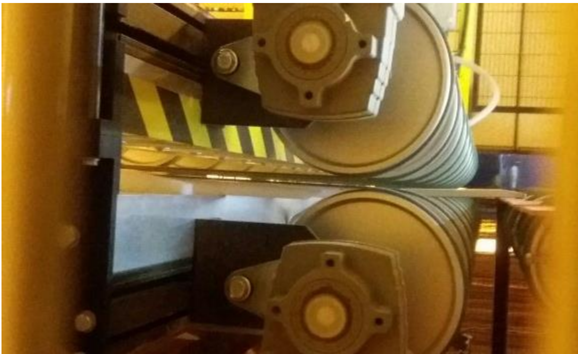
Kuva 7. MVA -kosteusanalysaattori toiminnassaan
