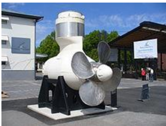
Kuva 1. Ensimmäinen asennettu Azipod-yksikkö. [15.]
