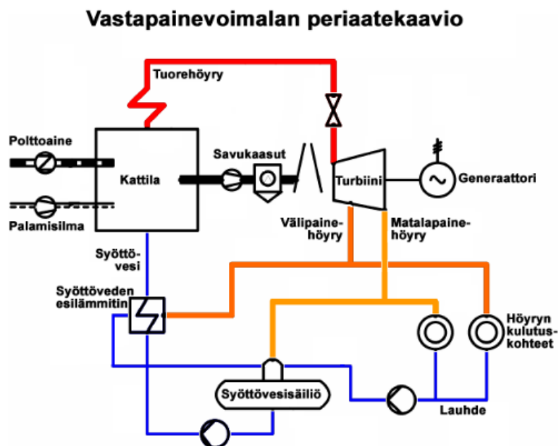
KUVA 3. Vastapainevoimalaitoksen periaatekaavio (Knowenergy 2012)
