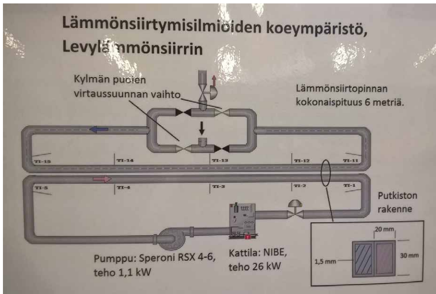
Kuva 3. Lämmönsiirtimen prosessikuva. Kuva. Xamk.
