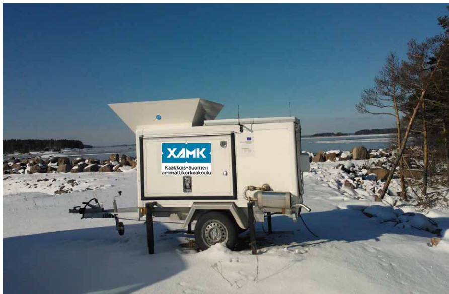
Kuva 15. Tuulimittauslaitteisto asemissaan mittauspaikalla. Kuva. Xamk.
