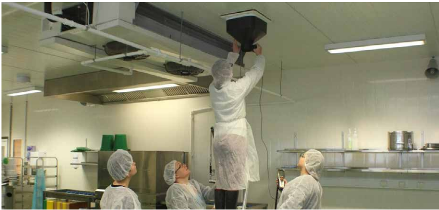
Kuva 16. Ilmamäärämittaukset Xamkin asiakaskohteessa. Kuva. Juha Palmu Kymijoen Ravintopalvelut Oy.
