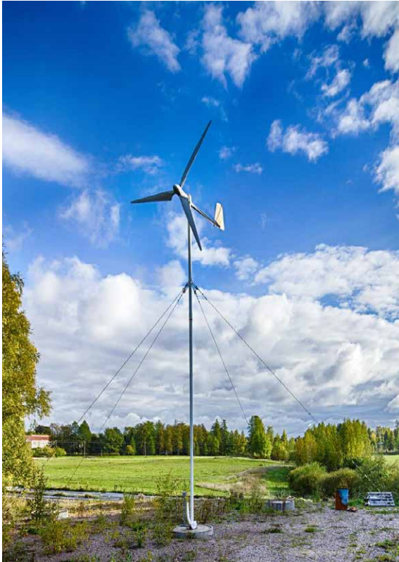
Kuva 37. BioSammon nimellisteholtaan 2 kW:n tuuliturbiini. Kuva. KSAO.
