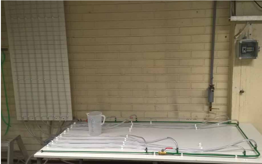
Kuva 14. Putkiston vastusmääritysten laboratoriolaitteisto Xamkin energiatekniikan laboratoriossa. Kuva. Xamk.
