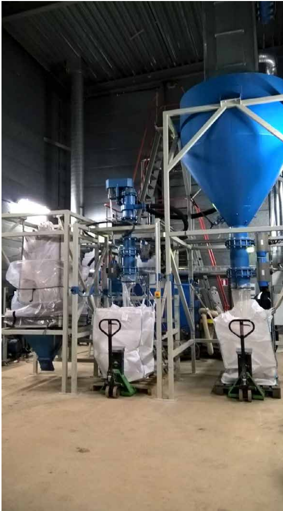
Kuva 10. Xamkin tuhkanerotuslaitteisto. Käytetään lentotuhkan tutkimuksiin. Sijaitsee Kotkan Korkeakoskella (Insuliitintieellä). Kuva. Xamk.
