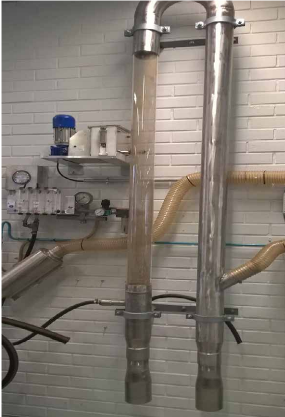
Kuva 9. Xamkin energiatekniikan laboratoriossa sijaitseva tuhkanerotuslaite. Kuva. Xamk.
