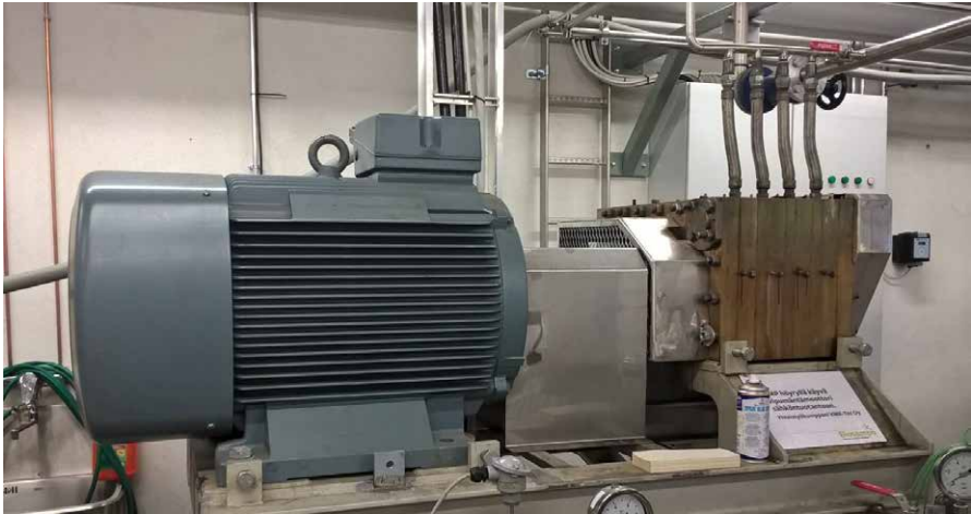
Kuva 34. Vipumäntämootori, 55 kW, BioSammossa. Kuva. Xamk.
