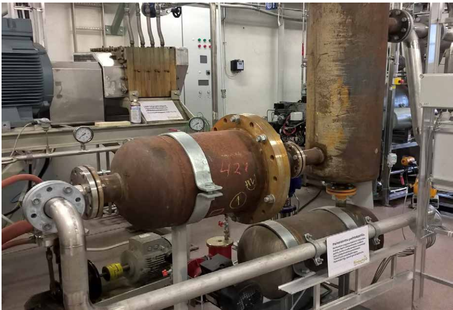
Kuva 35. Paineistettu polttokattila pyörömäntämootorille 15 kW. Kuva. Xamk.
