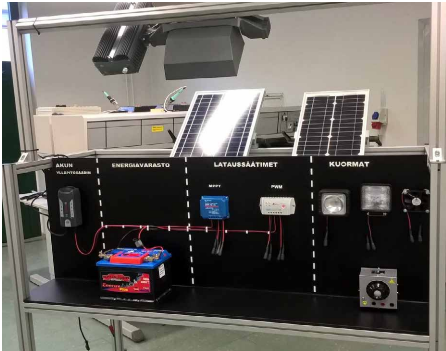
Kuva 11. Auringonsäteilytehon vaikutus sähköntuotantoon, simulointilaitteisto. Kuva. Xamk.
