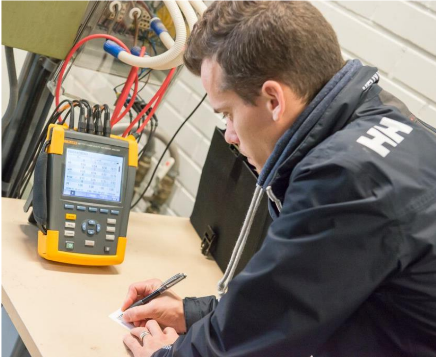
Kuva 19. Sähkönlaadun analysointilaite testikäyttöä Xamkin energiatekniikan laboratoriossa. Kuva. Xamk.
