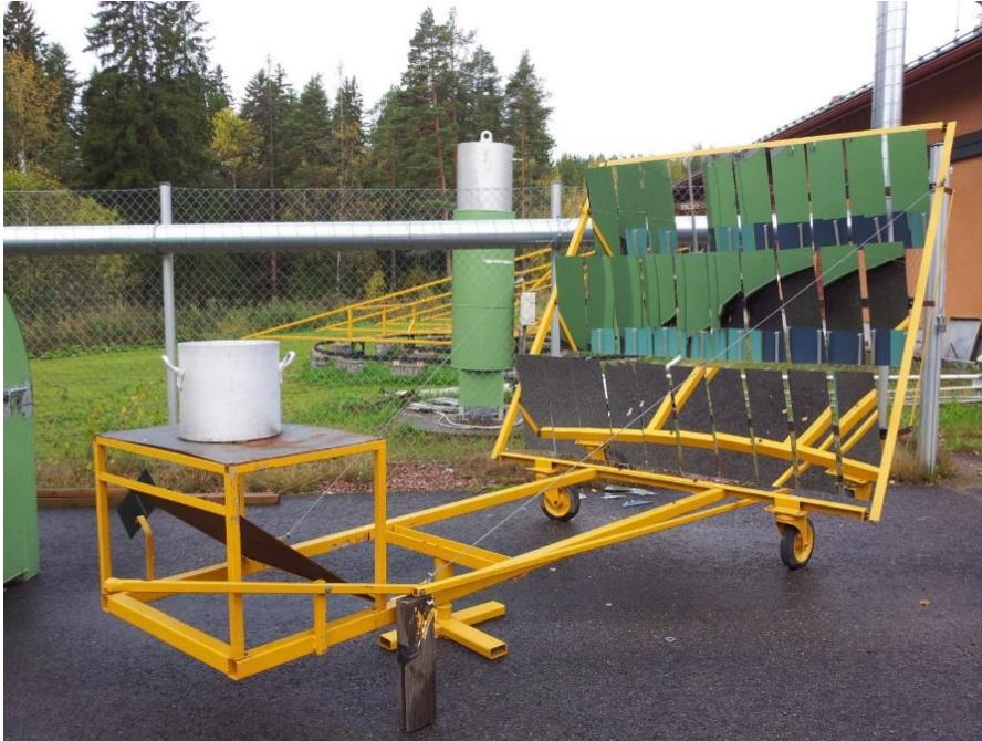
Kuva 38. Testimalli keskittävästä aurinkokeräinjärjestelmästä, kuvassa takana tulevan järjestelmän kehikko. Kuva. Xamk.
