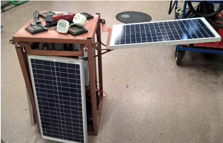
Kuva 40. Aurinkopaneelien asennuskulman ja -suunnan optimointiin hyödynnettävä mittalaite BioSammossa. Kuva. Xamk.
