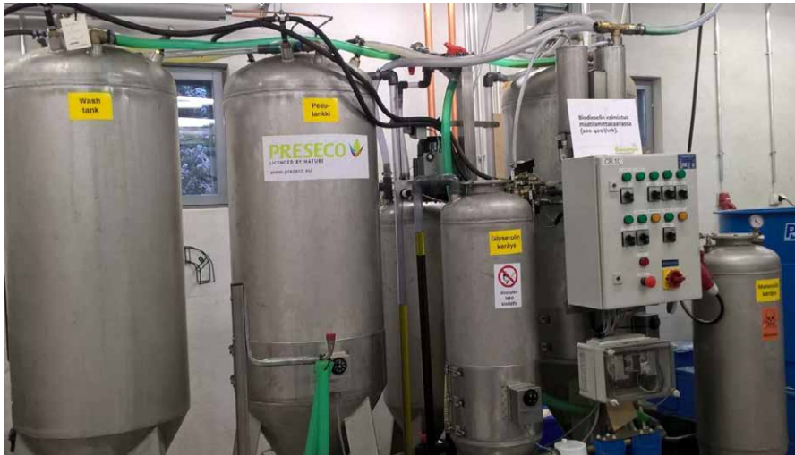
Kuva 24. Biodieselin valmistus maatilan mittakaavassa, laitteisto BioSammassa. Kuva. Xamk.
