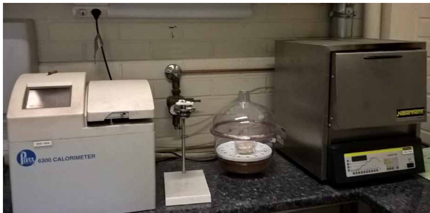
Kuva 12. Polttoaineanalyysissä käytettäviä laitteita Xamkin energiatekniikan laboratoriossa. Kuva. Xamk.
