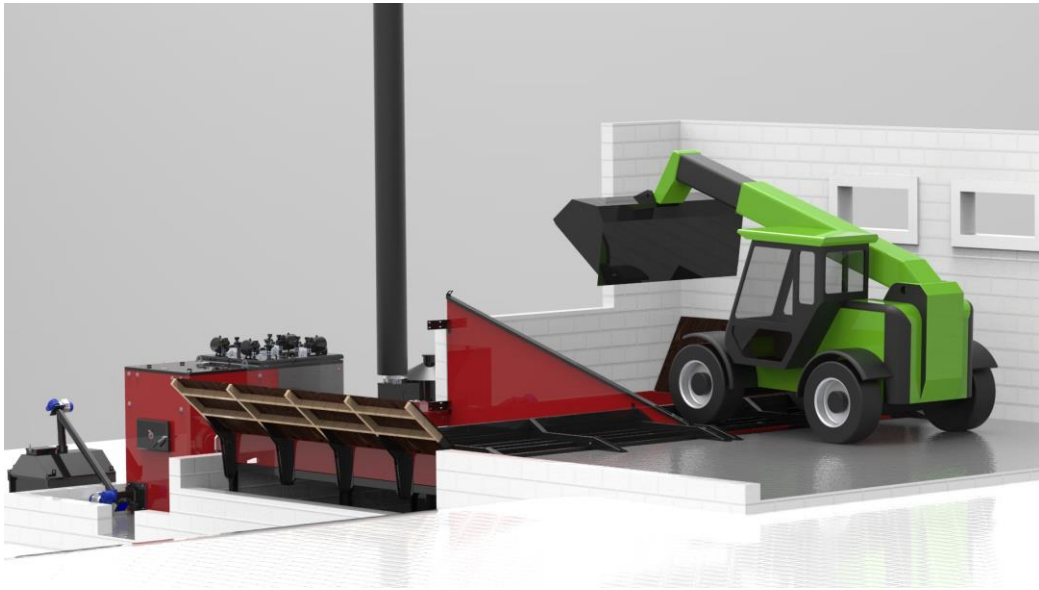
Kuva 15. Purkainlaitteisto asennettuna lämpökeskusrakennukseen, takaviistosta kuvattuna
