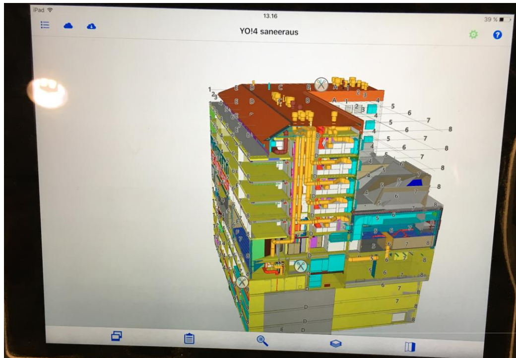
Kuva 6. Yliopistonkatu 4:n saneerauskohteessa Tekla Field3D on työmaatoiminnassa työnjohdon sekä asentajien käytössä ja soveltuu muun muassa iOS-käyttöjärjestelmiin.
