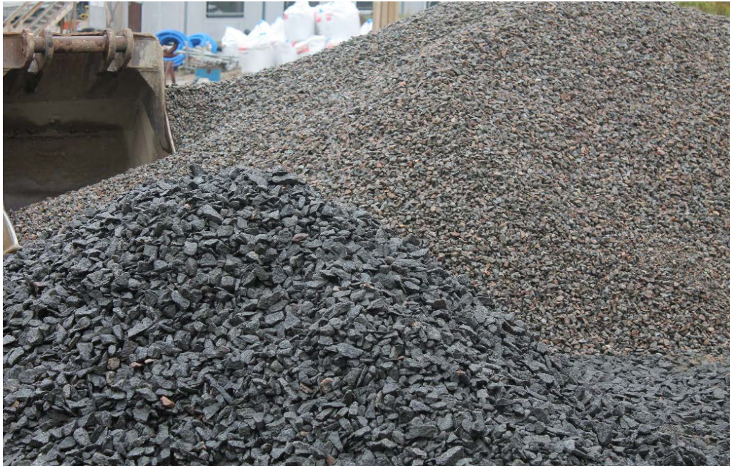
Kuvio 5. Uutta murskettä ja karkeaa sepeliä. Kuva Juha Seppänen
